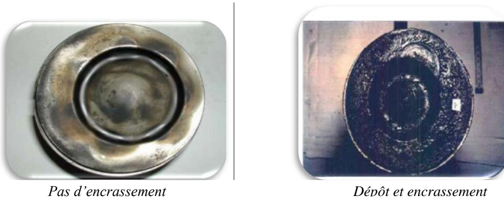
Figure 5: dépôts et encrassement des pistons [16]
