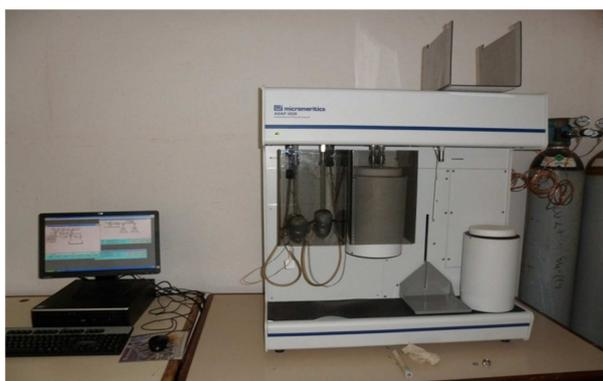
**Tableau 5: Appareil d'adsorption/désorption d'azote Micromeritics ASAP 2020**
