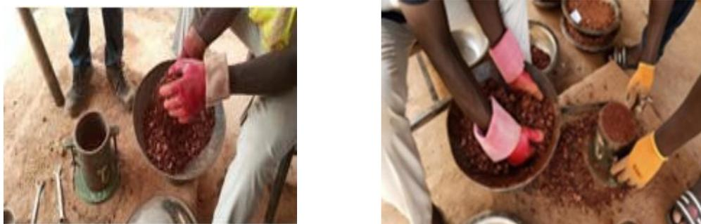
Figure 13 : a) Malaxage et b) Compactage dans un moule Proctor
