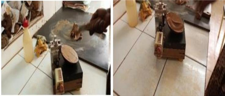
Figure 10 : Appareil de Casagrande
