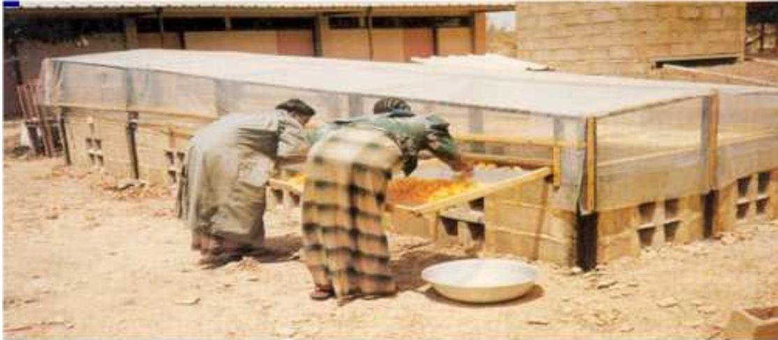
Figure 25: Séchoir solaire tunnel en Banco
