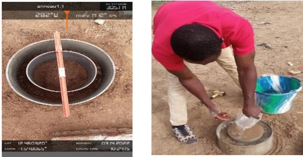
Figure 5 : Mise en place du double anneau et remplissage a rat
