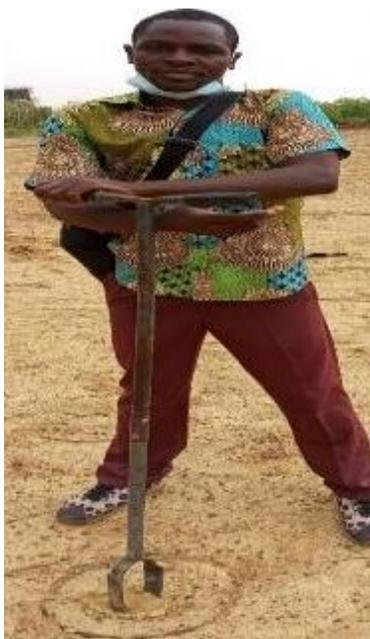
*Figure 9 : Prélèvement d'échantillon de sol à l'aide de la tarière*
