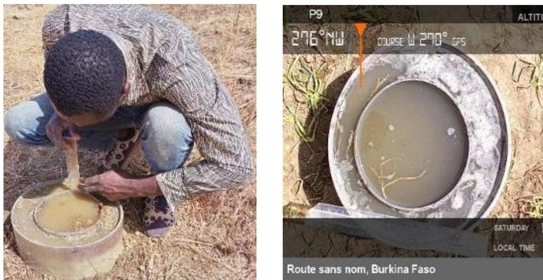
Figure 6: Mesures d'infiltrations au double anneau
