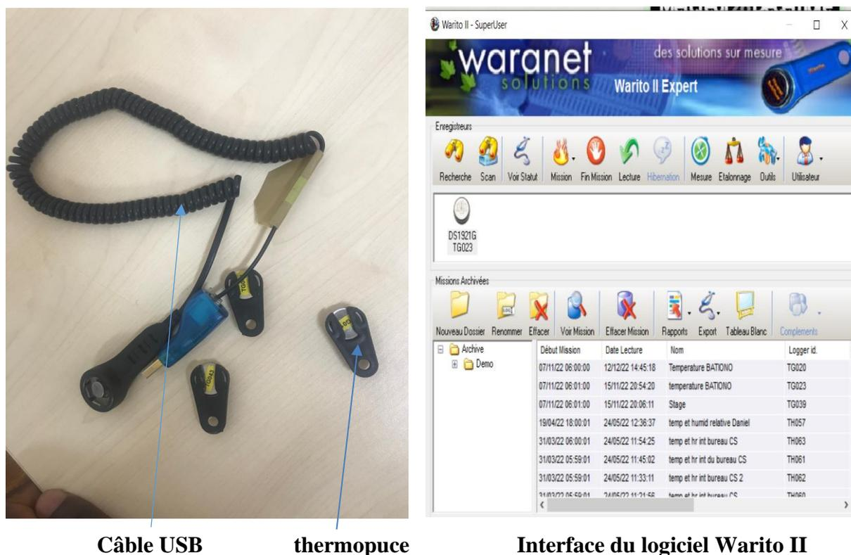
Figure II-2 : Appareils de collecte des températures
