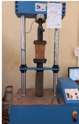
**Figure 6: Dispositif expérimental pour l'essai de compression**
