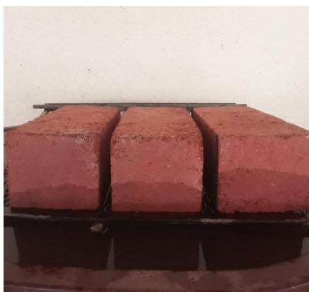
**Essai Absorption capillaire**
