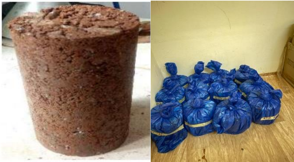
Figure 12: : Eprouvettes confectionnées et conservées dans du sachet plastique
