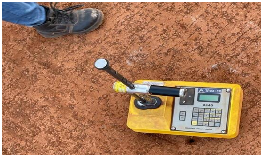
Figure 28: l'appareil Troxler utilisé pour l'essai de compacité sur le sol-ciment
