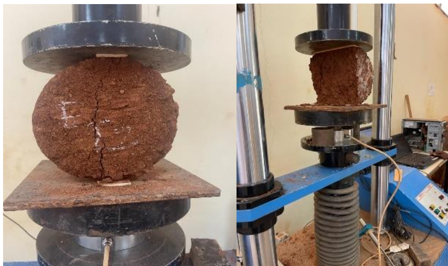
Figure 14: Illustration de l'exécution de l'essai de traction indirecte avec la presse hydraulique
