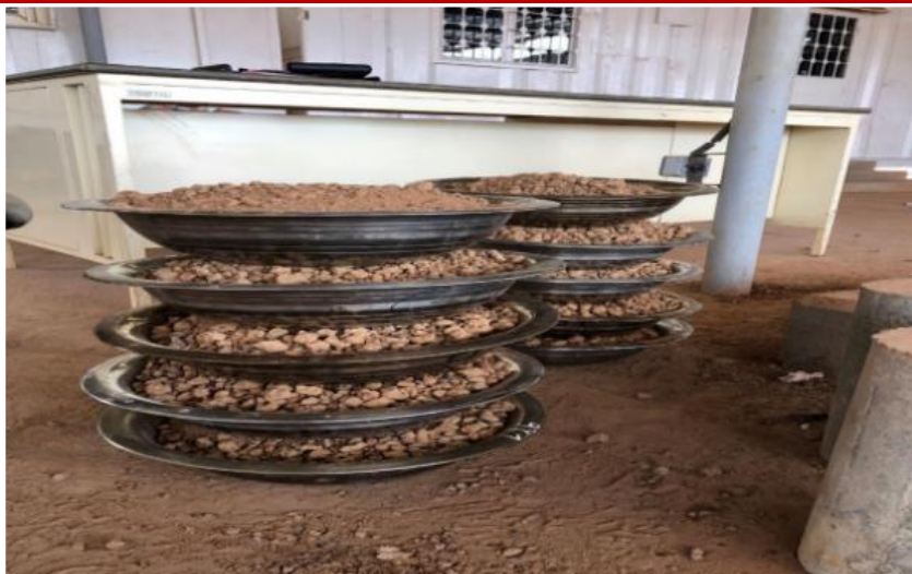
Figure 10: Matériau pesé et mis dans des tares pour l'essai Proctor
