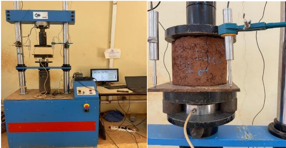
Figure 13: Exécution de l'essai de compression simple avec la presse hydraulique
