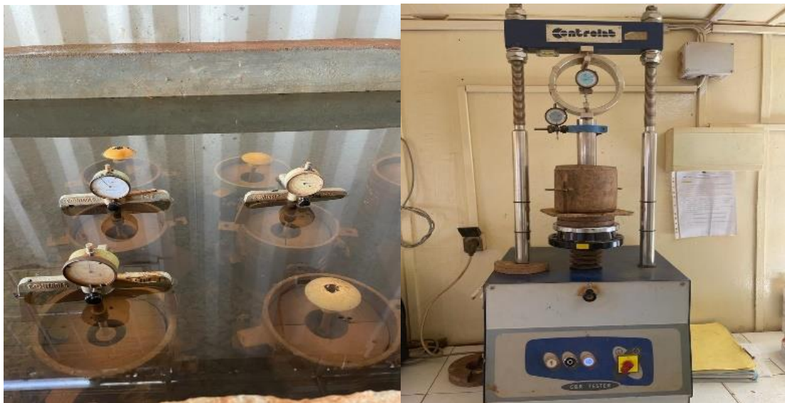
Figure 11: Moules CBR plongés dans un bac plein d'eau et appareil pour le poinçonnement
