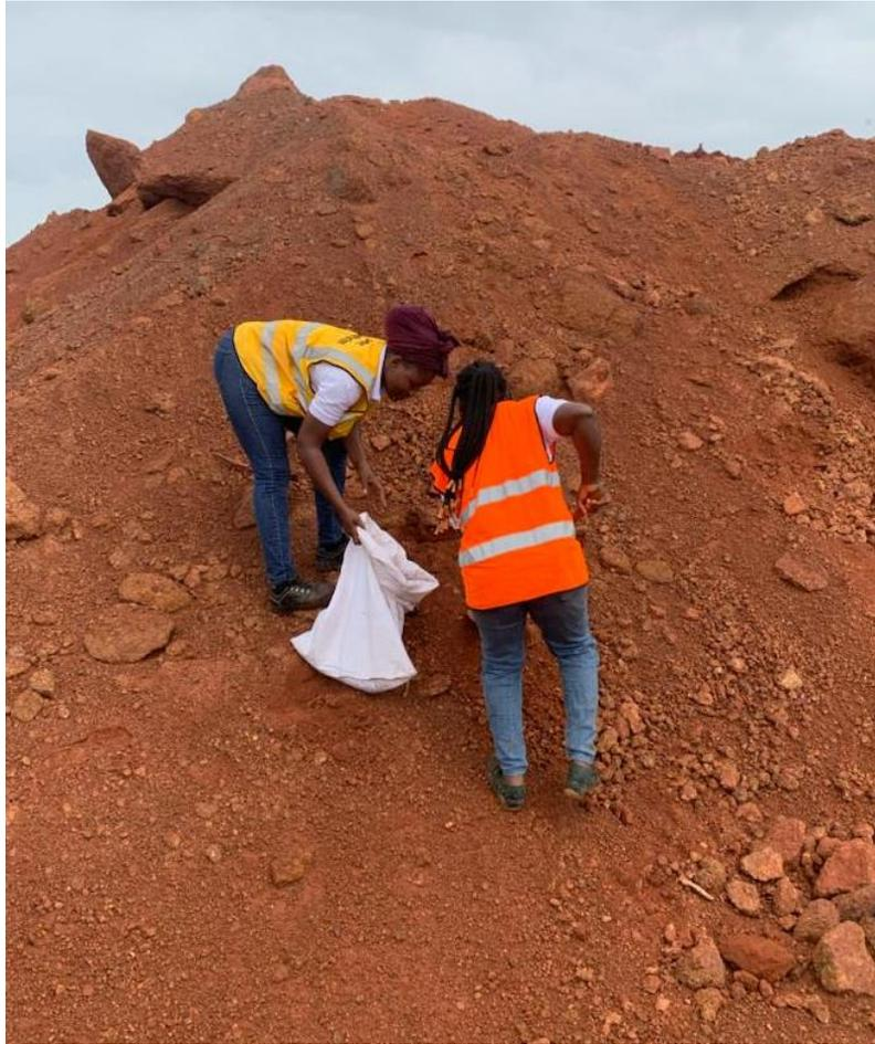
*Figure 5: Prélèvement de matériau latéritique*
