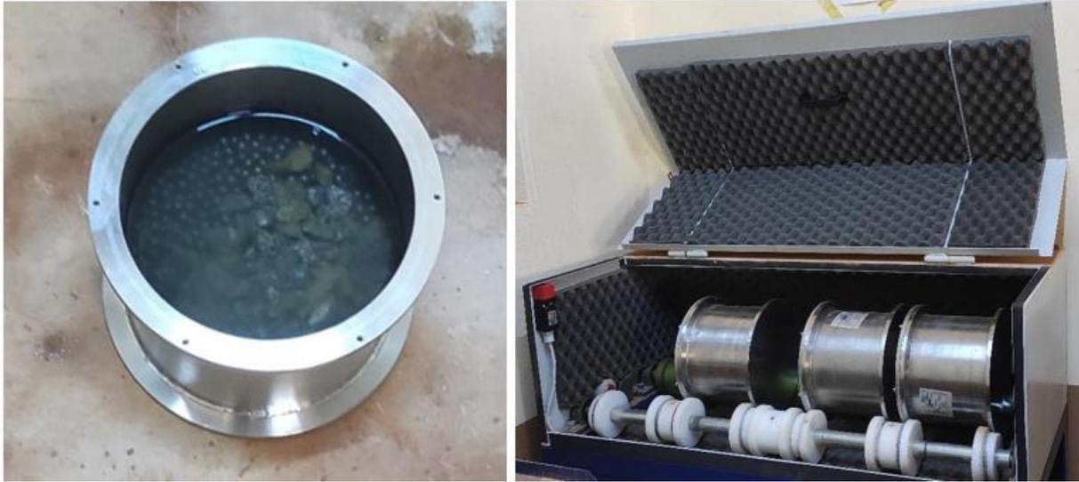
*Figure 13 : Cylindre contenant l'échantillon et les billes normalisées et l'appareil Micro- Deval*
