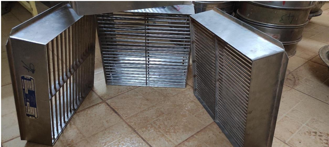
*Figure 11: Tamis à fente pour l'essai d'aplatissement*
