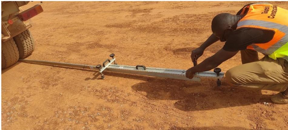
*Figure 31: Mesure de la déflexion à l'aide de la poutre de Benkelman*
