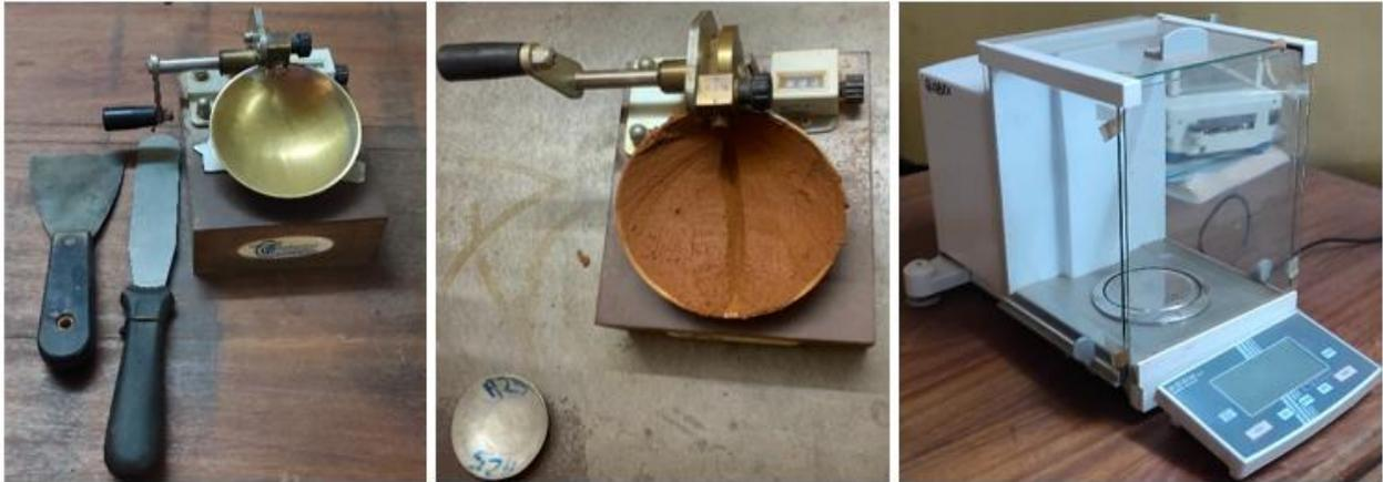
*Figure 10 : Matériels pour la limite d'Atterberg et la balance utilisée*
