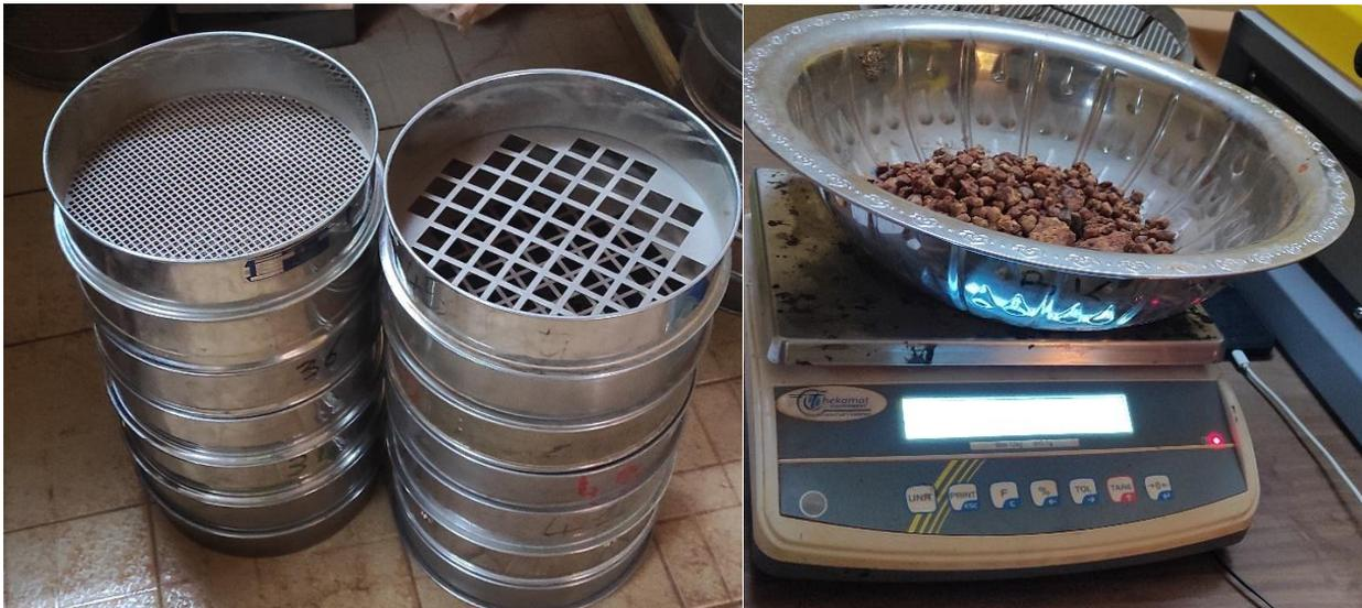
Figure 8: Tamis et balance pour la granulométrie
