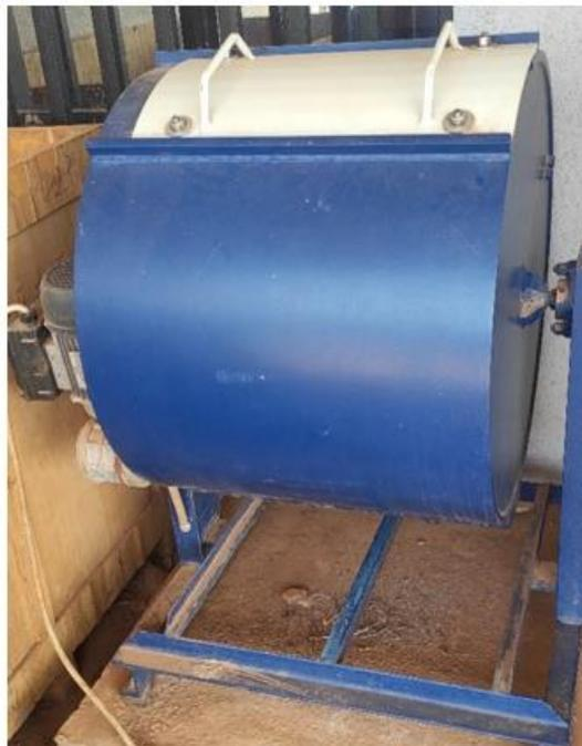
*Figure 12: Echantillon, billes normalisées et appareil pour l'essai de Los Angeles*
