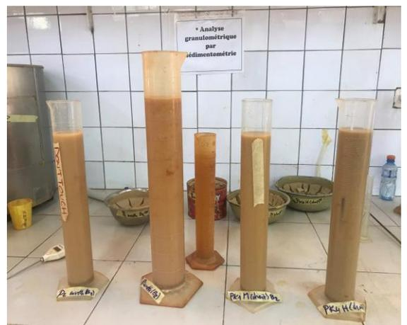
Image 4 : essai sédimentometrie
