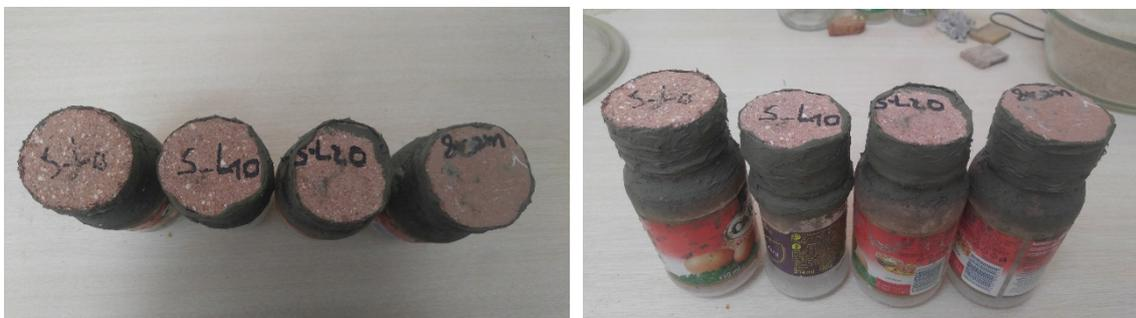
Figure 67: Echantillons de Saaba après essai de perméabilité à la vapeur
