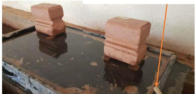
Figure 61: Essai d'absorption par capillarité
