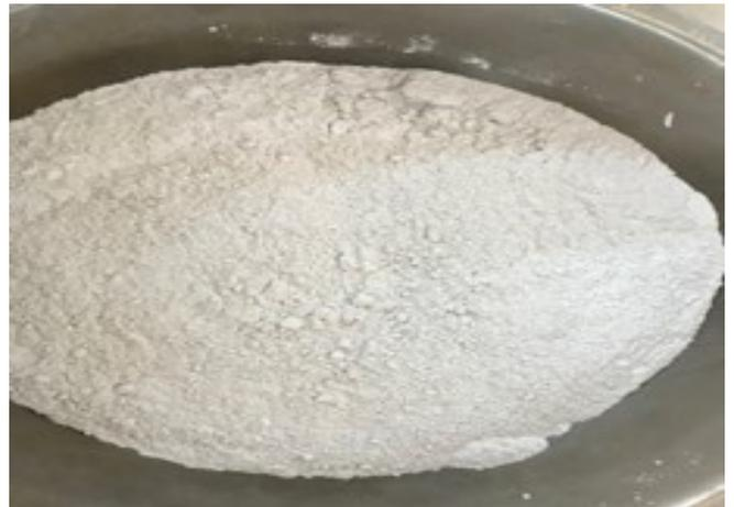
Figure 45: Poudre de CCR tamisé à 80micromètre
