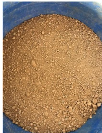
Figure 53: Terre argileuse de Kossodo passée au tamis de
