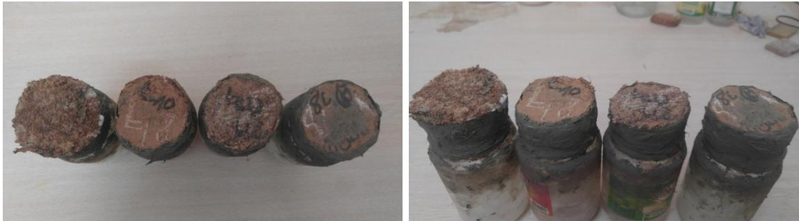
Figure 66: Echantillons de Kossodo après essai de perméabilité à la vapeur
