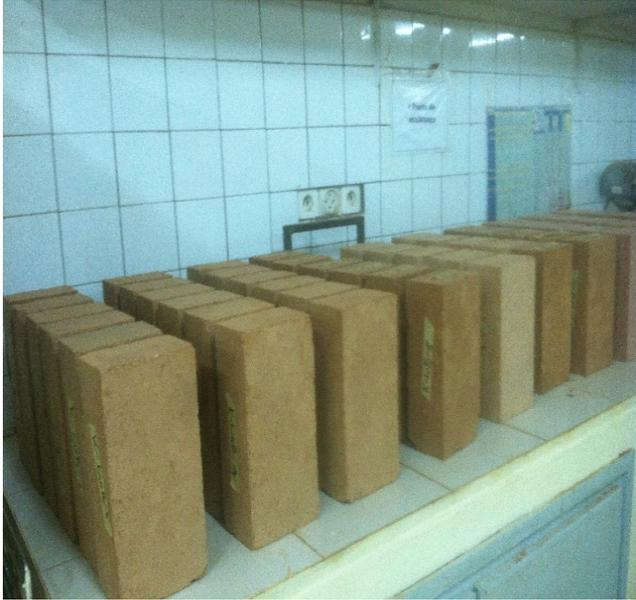
Figure 59: Entreposage des briques après séance de pesage
