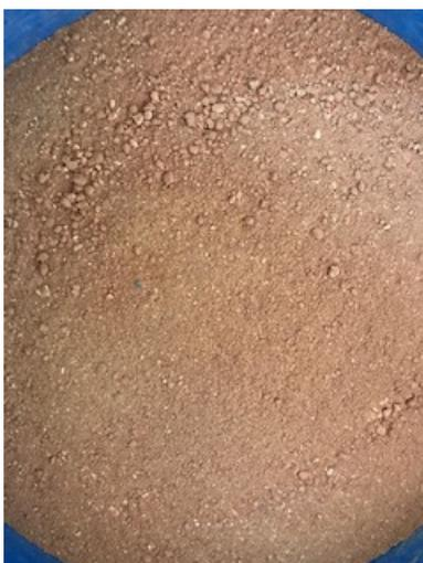
Figure 52: Terre argileuse de Saaba passée au tamis de 5mm
