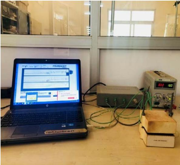
Figure 62: Dispositif DESPOTHERM pour acquisitions thermiques d'abrasion
