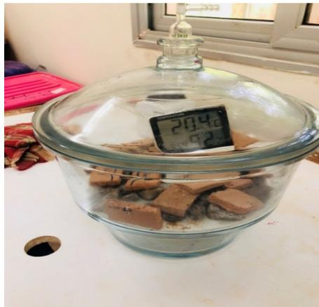
Figure 64: Dispositif pour essai de sorption désorption
