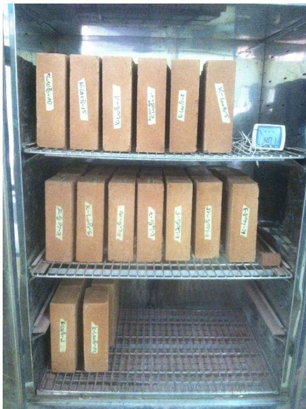
Figure 57: Etuve utilisée pour séchage des briques
