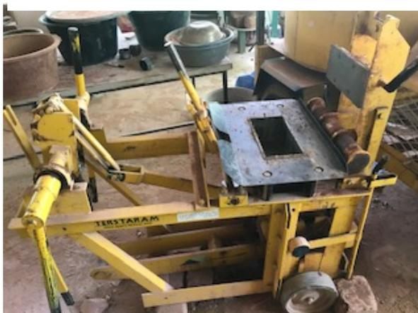
Figure 56: Presse TESTARAM utilisée pour confection des
