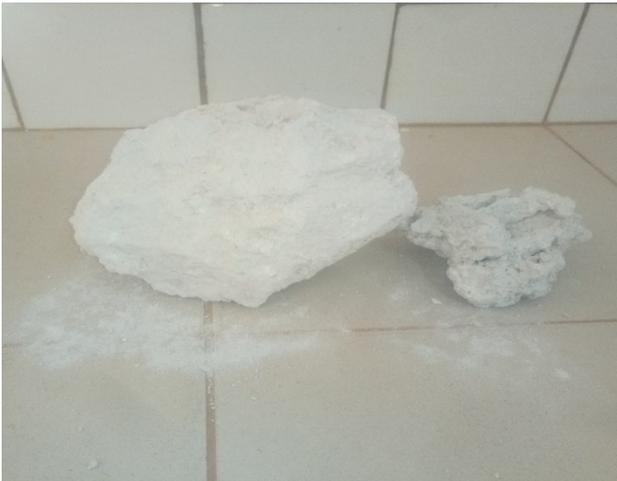
Figure 44: Flocc de CCR non broyé, ni tamisé
