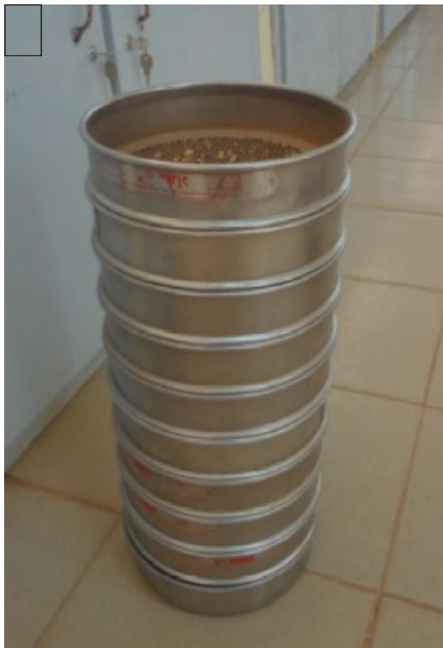
Figure 55: Piles de tamis prêt pour analyse granulométriques
