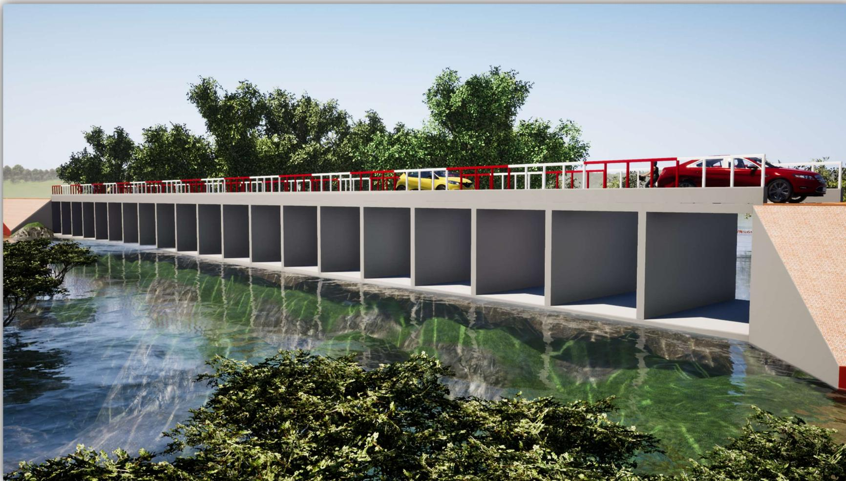
**Image 3 : Vue en 3D du dalot 4x(5x4.00x4.00), source, SIBA Souleymane, ArchiCad & Twinmotion, 14-12-2022**
