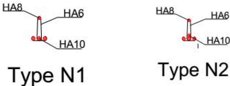
Figure III-1 : schéma de ferrailage des poutrelles
