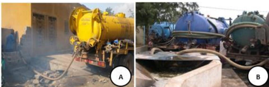
**Figure 4:** Vidange mécanique (DIONGUE, 2006) ; A = vidange au niveau du ménage ; B = vidange au niveau de la station
