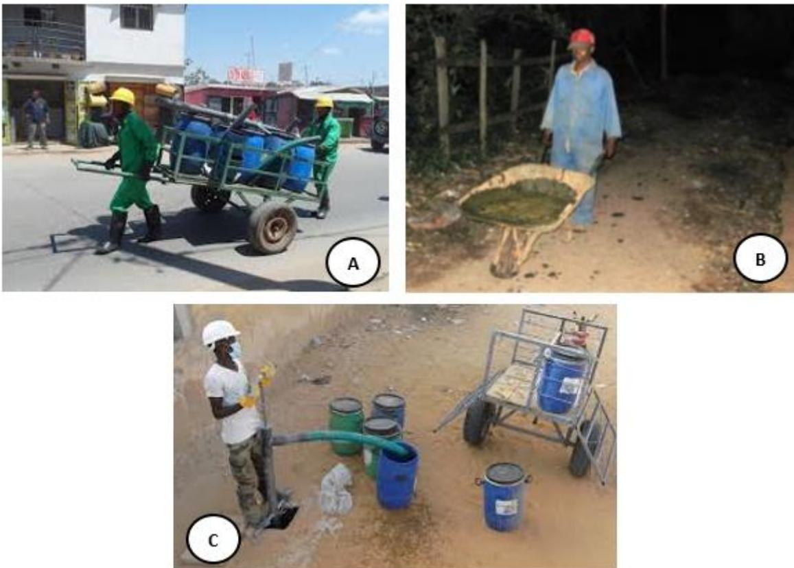
**Figure 5:** Transport des boues de vidange ; A et B = Transport à propulsion humaine ;
