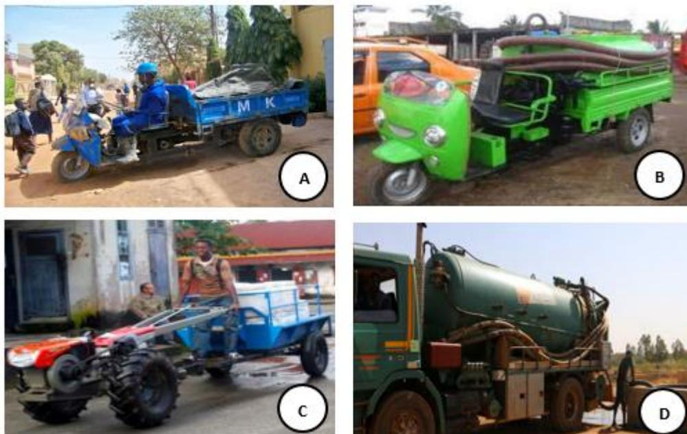
**Figure 6:** Transport motorisé (AFWA/AAE, 2021 ; Réseau Projection, 2016) ; A= Tricycle contenant de la matière fécale ; B= Tricycle contenant à l'arrière un réservoir pour la vidange ; C= Tricycle contenant à l'arrière un fut pour la vidange ; D= Camion de vidange
