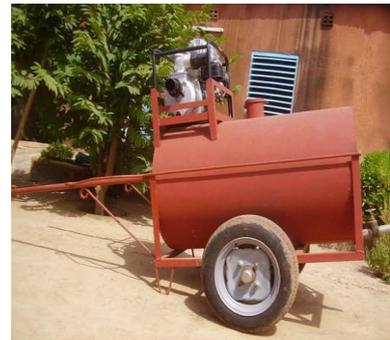
Figure 20 : Equipement de transport à traction asine
