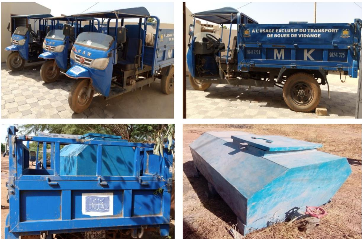
Figure 23 : Equipement de transport motorisé muni d'un réservoir
