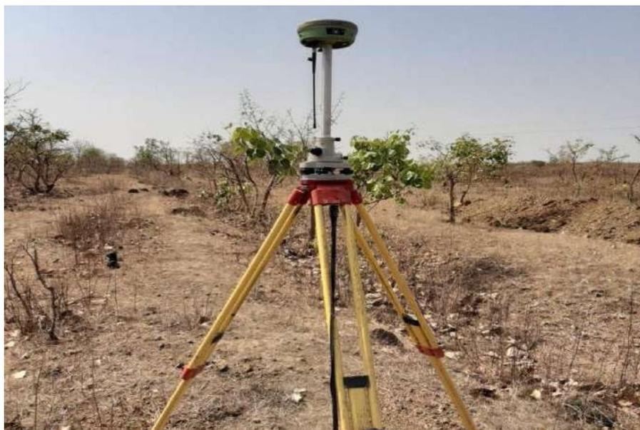
*Figure 9: GPS différentiel STONEX utilisé dans le cadre des levés topographiques*
