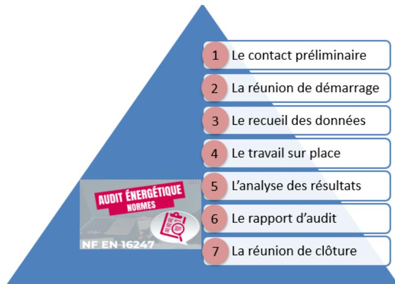
Figure 2 : Les étapes chronologiques de réalisation d'un audit énergétique
