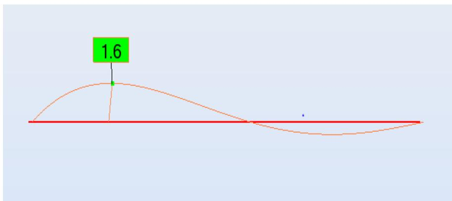
Figure 29: Déformée de la lisse UAP200 sous la combinaison ELS
