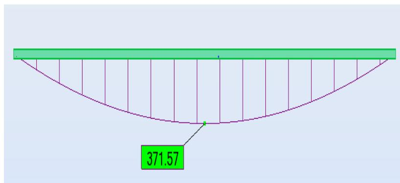
Figure 17: Diagramme du moment fléchissant  $M_y$  sous la combinaison ELU
