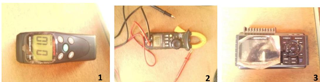
**Figure 7 :** Solarimètre (1), Multimètre numérique (2) et thermocouple (3)
