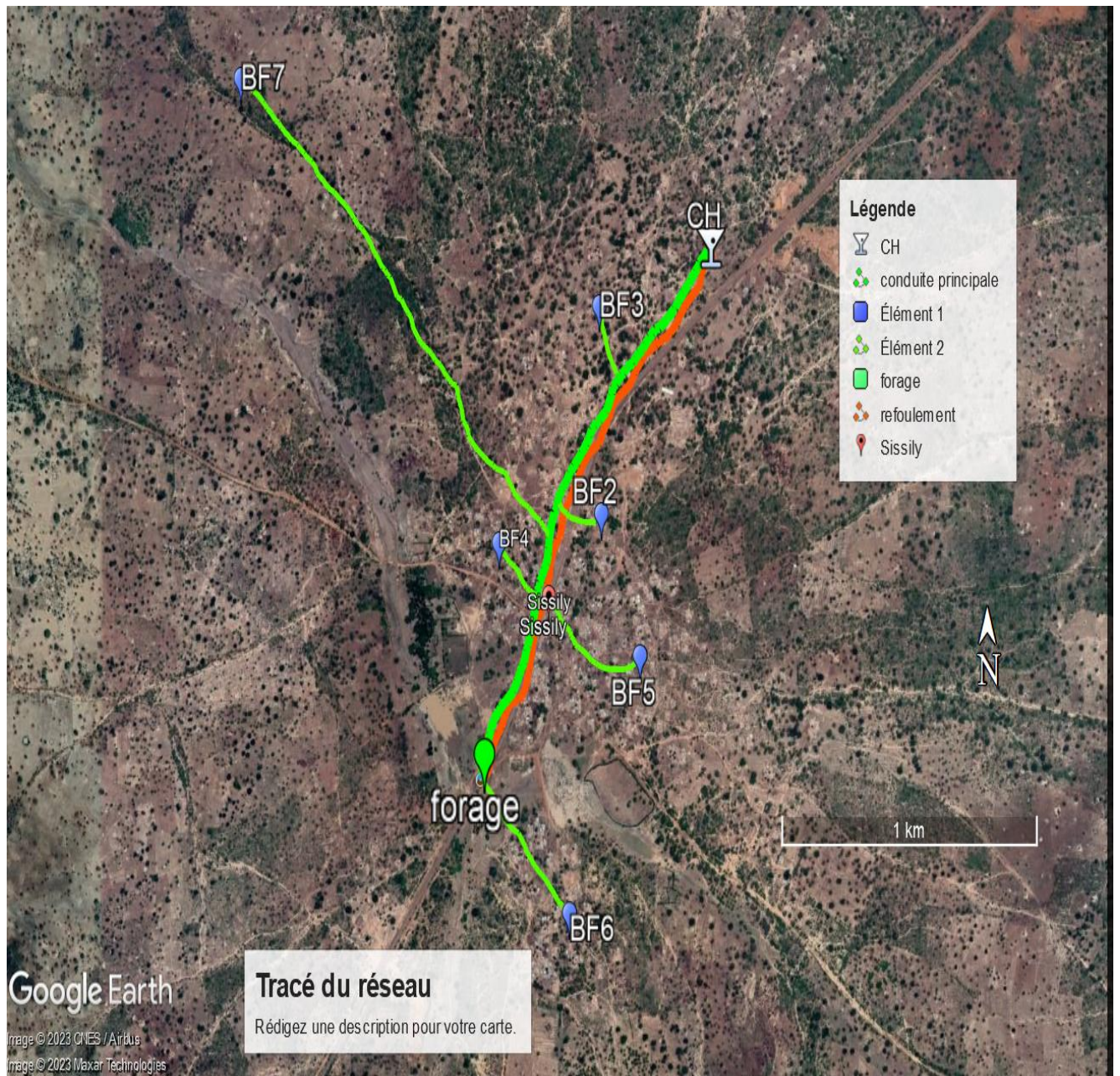
Figure 8: Tracé sommaire du réseau
