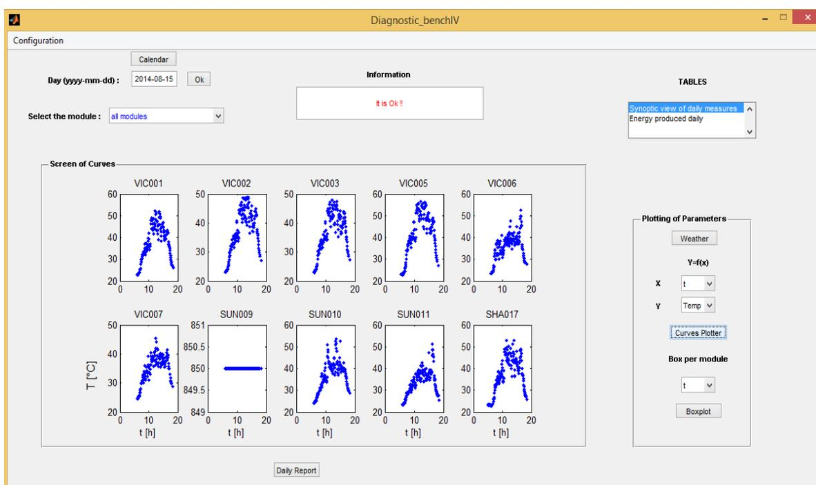
**Figure A.1** : Interface graphique de l'application Matlab conçue pour le suivi journalier du fonctionnement du banc I-V du 2iE.
