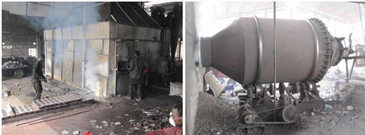
Figure 4. 14 Fours à plomb secondaire, le haut fourneau à gauche et le four rotatif à droite (Manhart & Schleicher, 2015)
