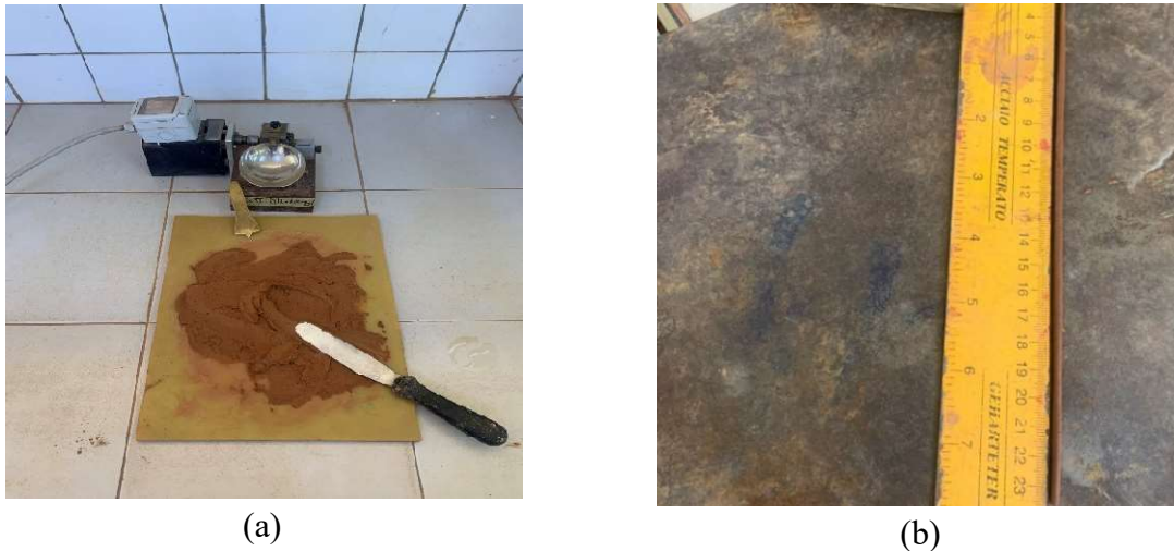
Figure 2-7. a) dispositifs de détermination de w_L ; b) Rouleau de sol pour w_p
