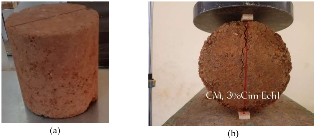
Figure 2-12 : Éprouvette a) Après confection, b) soumise à la traction indirecte
