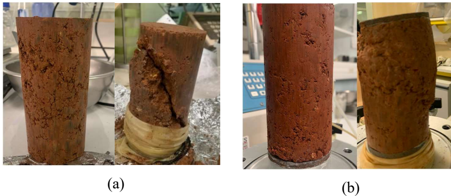
Figure 4-15 : Photos d'illustration des échantillons améliorés à 3% de ciment avant et après essai : a) Saaba, b) Kamboinsé
