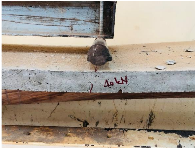
Figure IV- 25 : Apparition de fissures transversales sur les faces latérales pour 40 kN de charge environ
