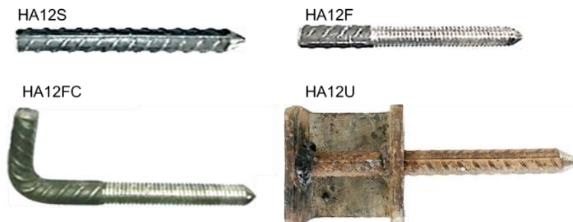
Figure III- 4 :Photo de quatre configurations de connecteurs; HA12S; HA12F; HA12FC; HA12U.
