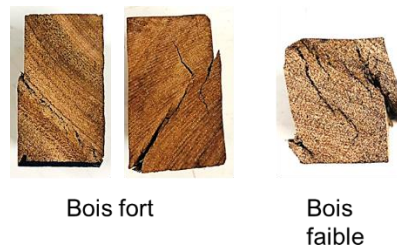
Figure II- 8 : Mode de ruine de l'essai de compression transversale
