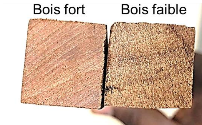
Figure II- 20: aperçu de la section transversale des deux types de bois
