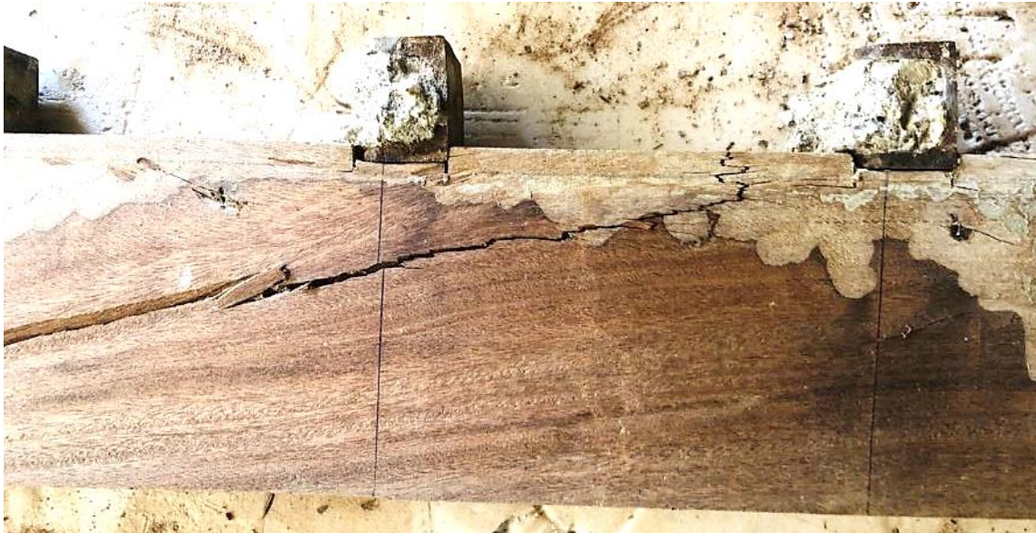
Figure IV- 17 : ruine par cisaillement
