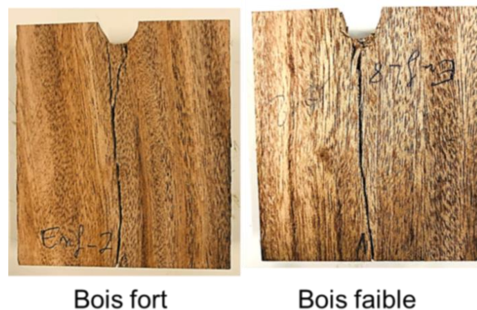
Figure II- 19 : Mode de ruine des bois après l'essai de l'enfoncement
