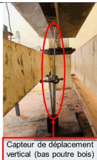
Figure IV- 10: position du capteur de flèche sous la poutre de bois
