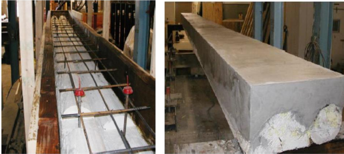
Figure I- 9: Exemples de poutres bois-béton réalisé en bois rond (Meghlat, 2015)
