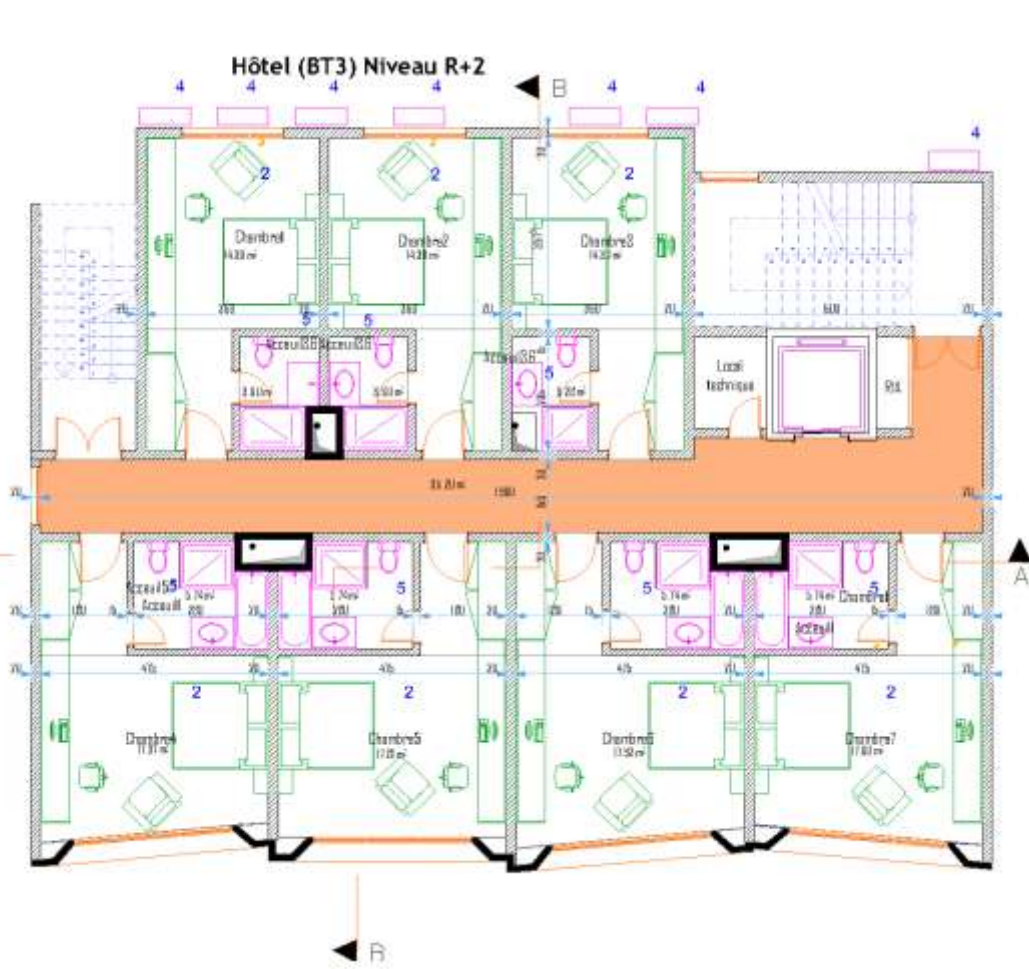
Plan du Bâtiment Tertiaire 3 niveau R+2
