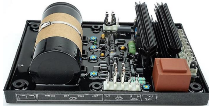
Figure 16 : Régulateur automatique de tension R448 [24]
