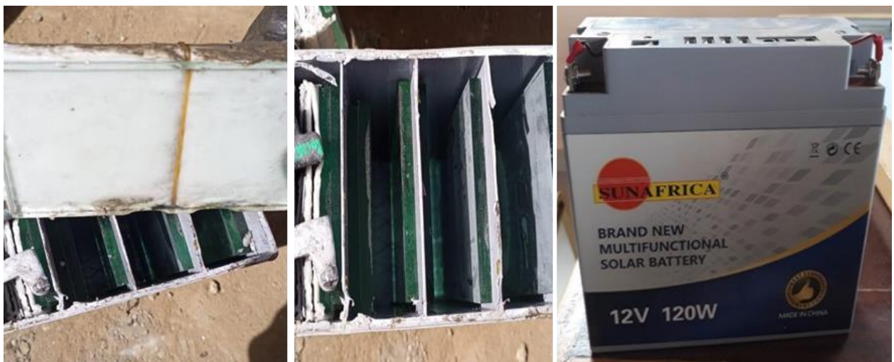
Figure 1: Batterie neuve ouverte contenant du verre et du ciment
