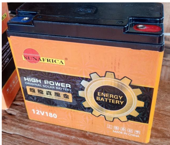
Figure 16: Batterie avec étiquette non conforme
