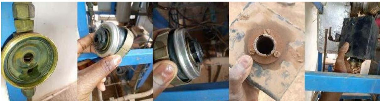
**Figure 21 : Nettoyage du circuit de refroidissement de l'alternateur**
