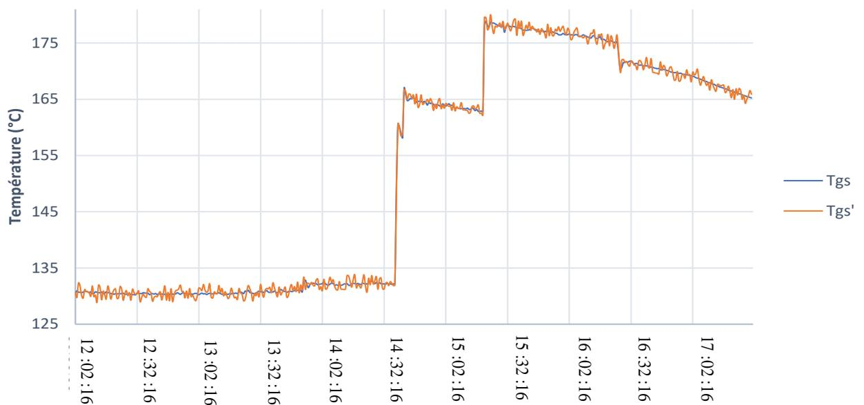
**Figure 27: Température de l'huile de jatropha à la sortie du générateur issu de l'expérimentation(Tgs) et de la modélisation(Tgs')**
