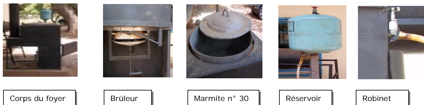
Figure 5 : prototype du foyer à huile végétale (LBEB/2ie)
