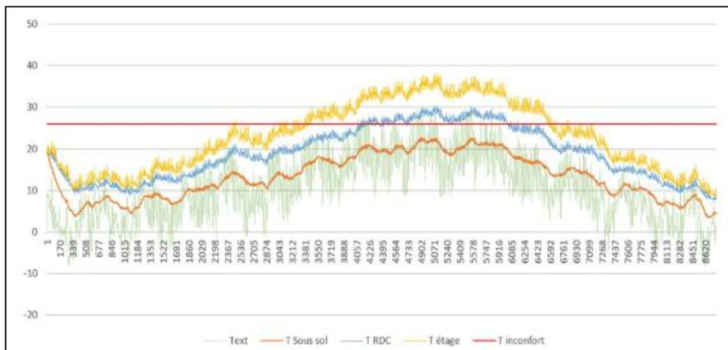
**Figure IV-4 : Evolution de la température du bâtiment sur année type (scénario 1)**
