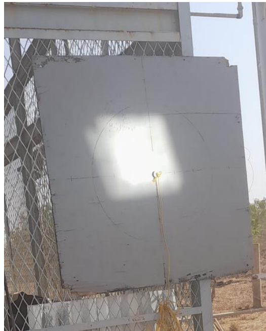
Figure 26. Illustration de la tâche focalisée des miroirs après correction
