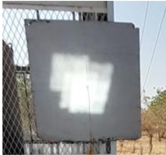
Figure 15. Illustration de la tâche focalisée des miroirs
