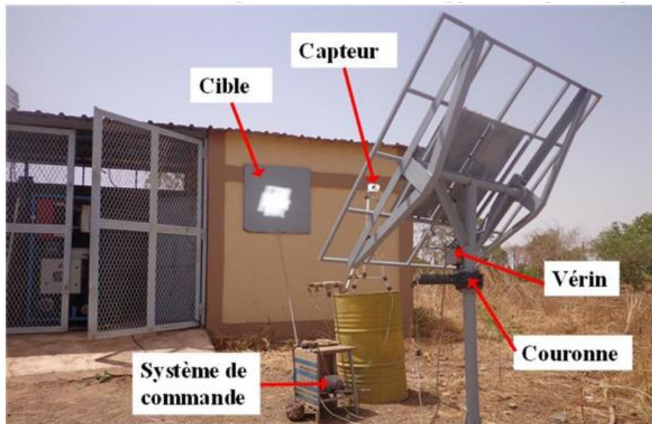
Figure 13. Dispositif de test de suivi solaire [2]
