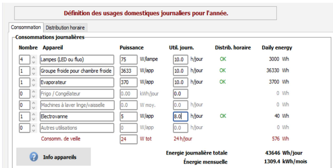
Figure 15 : Résultats de la consommation énergétique de l'installation pour la chambre froide
