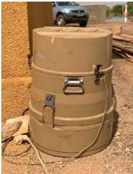
Figure 8 : Échantillonneur ISCO
