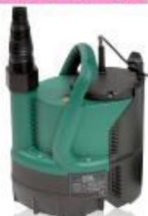
Les **VERTY NOVA** sont des pompes submersibles avec flotteur intégré spécialement conçues pour des puisards d'évacuation aux dimensions réduites (minimum 20 cm x 20 cm). Destinées au pompage d'eaux propres contenant des particules solides d'un diamètre maximum 5 mm. La température du liquide à pomper ne doit jamais dépasser les 35°C.
