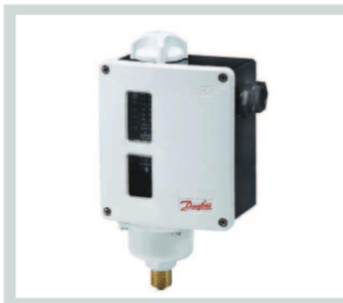
Les pressostats RT comportent un contact inverseur unipolaire commandé par pression. La position de ce contact est fonction de la pression d'entrée et de la valeur de consigne.
