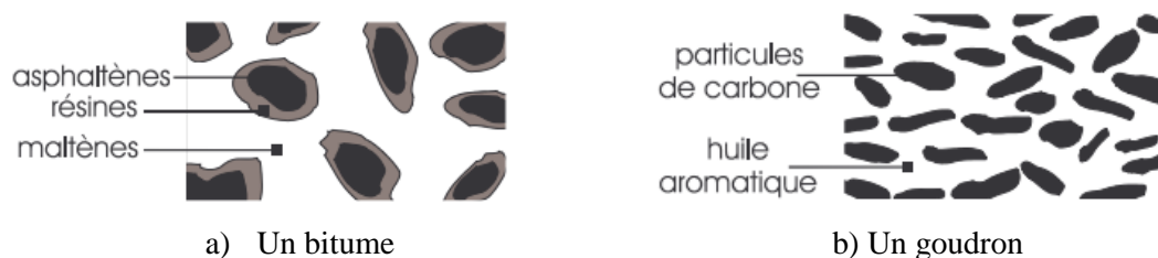
Figure 3: Représentation schématique de la microstructure d'un bitume et d'un goudron
