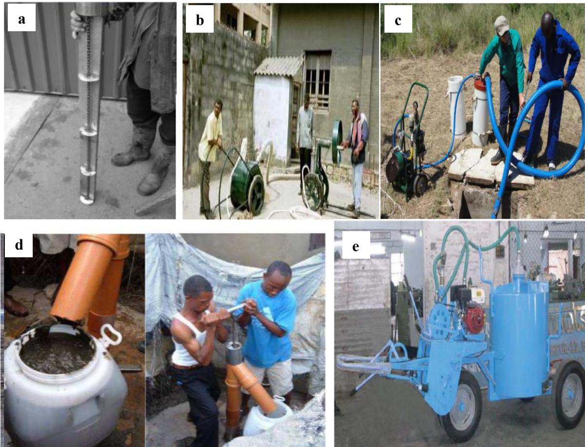
**Figure 4: Technologies de la vidange manuelle mécanisée (O’Riordan, 2009) :** (a)Pompe Nibbler, (b)Pompe MAPET, (c)E-Vac, (d)Pompe Gulper, (e)Vacutung
