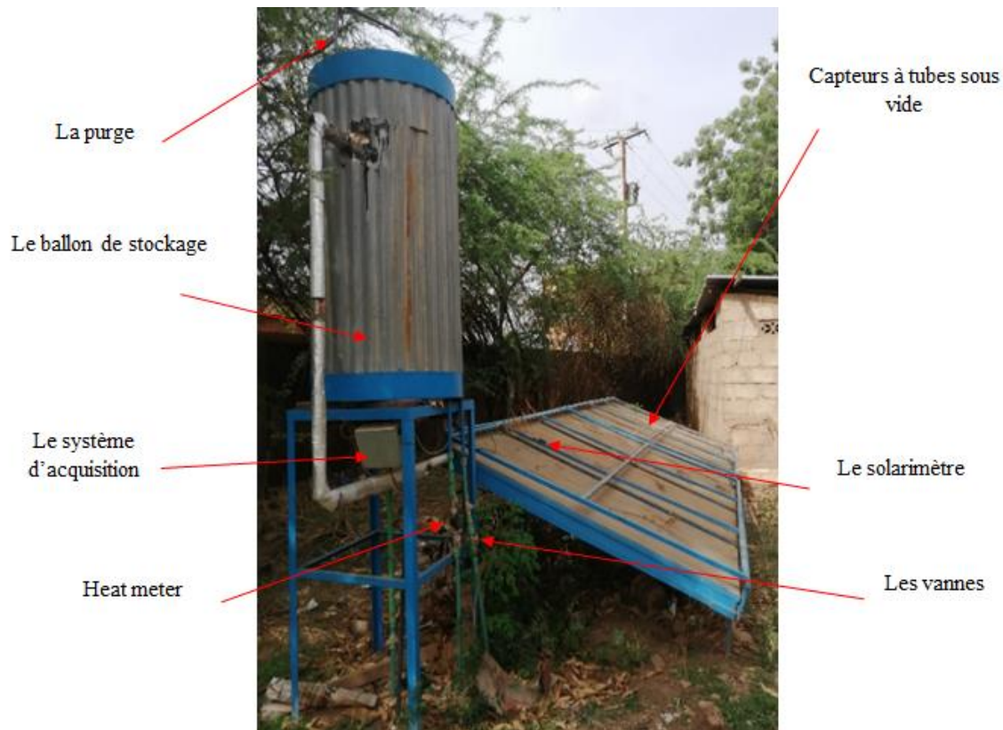
Figure A.3. Schéma illustratif de l'installation de ST instrumentée sur le site.
