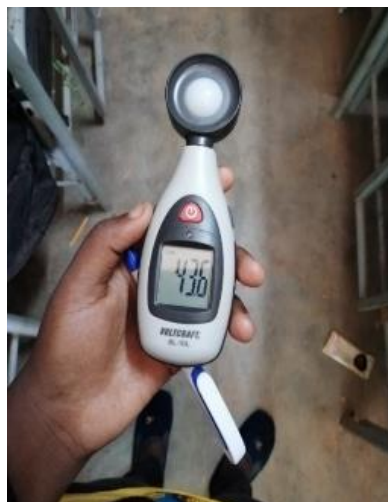
Figure 14. Illustration d'une mesure d'éclairement dans la chambre des filles avec le luxmètre.
