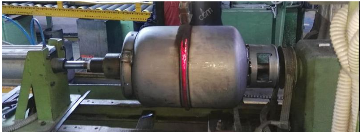
Figure 16 : Le soudage circulaire
