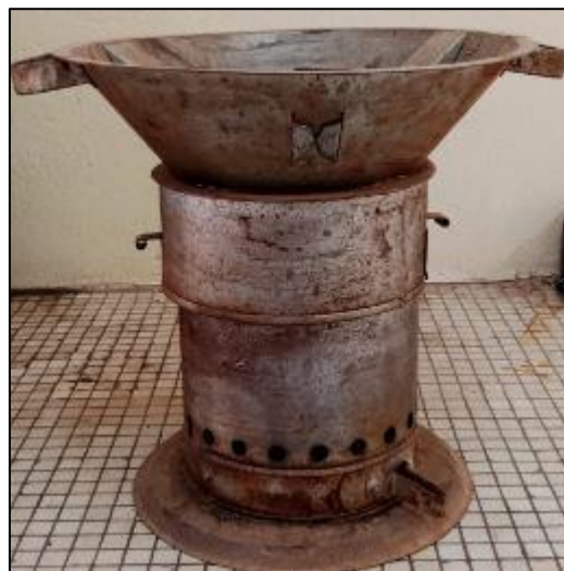
Figure 6 : Foyer à pyrolyse
