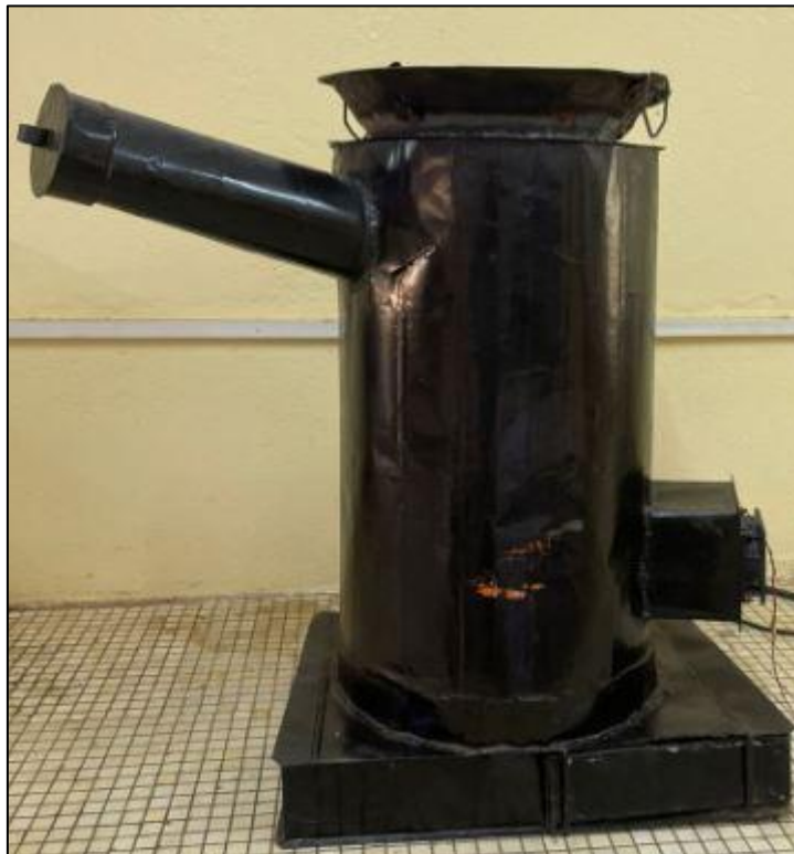
Figure 16 : Vue en face du foyer à pyrolyse réaliser
