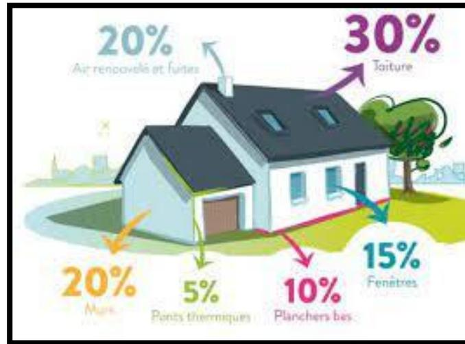
Figure 9: Pertes rencontrés sur un bâtiment non isolé
