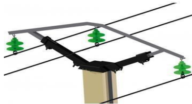
Figure 7 : Lignes à isolateurs suspendus (KAGAMBEGA, ETUDE D'ELECTRIFICATION DE LA LOCALITE DE KAYA NAVIO, 2019)
