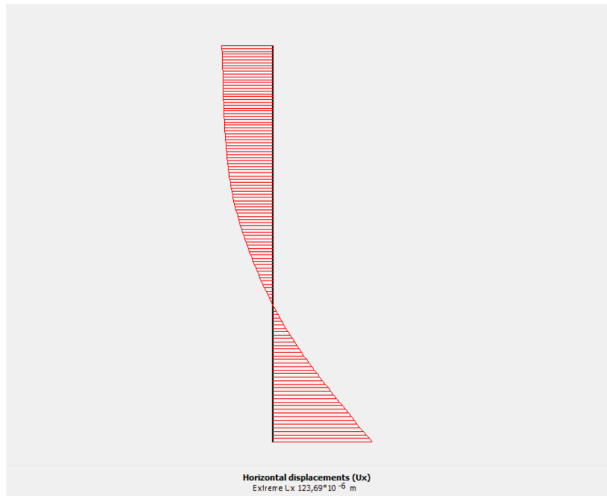
Figure 28: Déplacement horizontal P7
