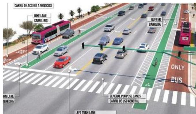
***Figure 12: Configuration du BRT bilatéral***
