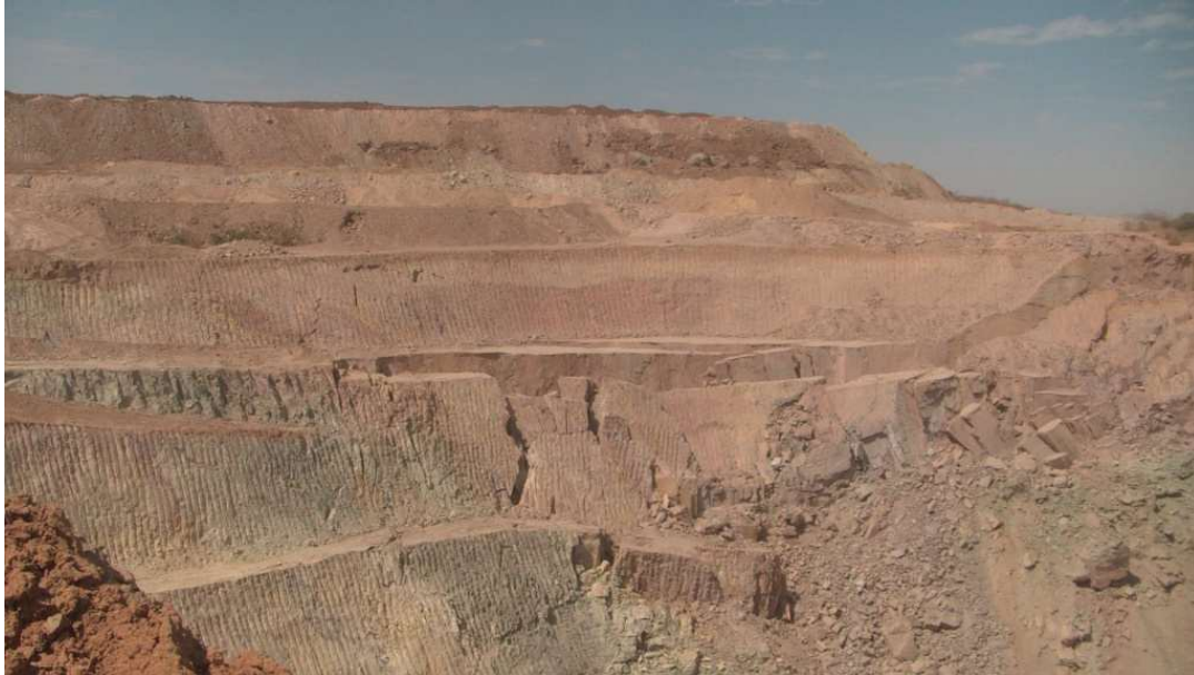
Photo 1 : Effondrement des flancs d'une fosse.
