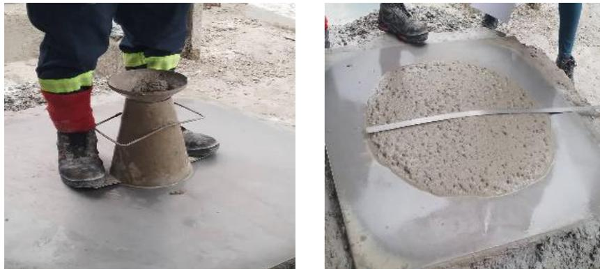
**Figure III-2 : étalement au cône d Abrams**
