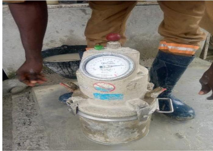
Figure III-3 : Mesure de la teneur en air
