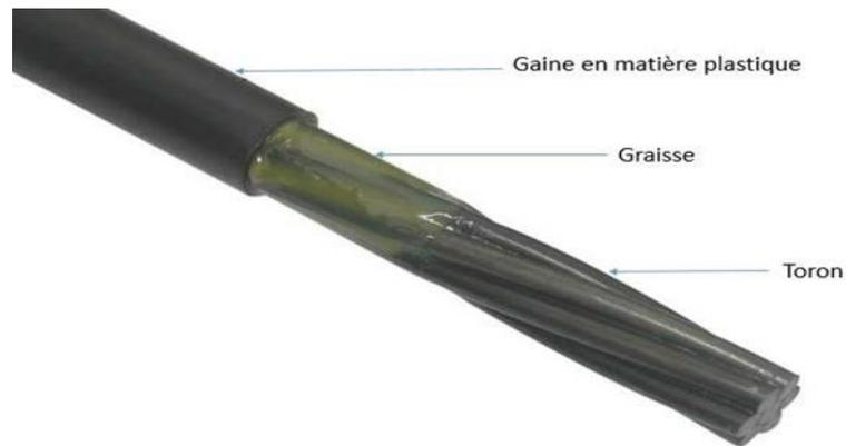
Figure III-1 : Cable de précontrainte
