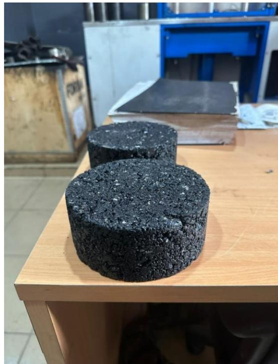
Image 4 : Éprouvettes d'orniérage et de module de rigidité
