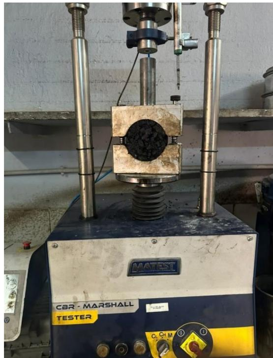
Image 2 : Écrasement des éprouvettes à la presse Marshall
