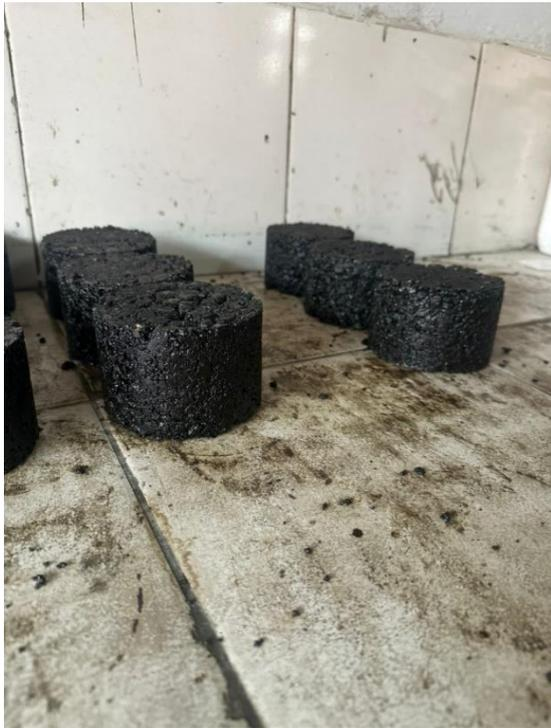
Image 1 : Éprouvettes Marshall
