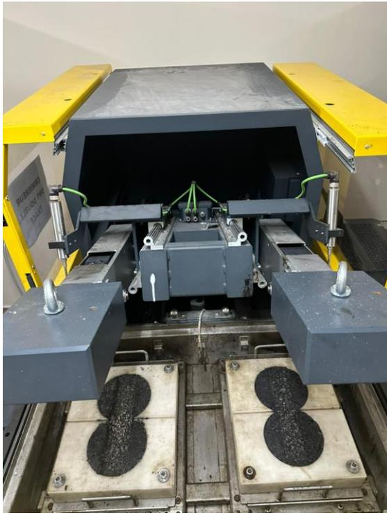
Image 5 : Éprouvettes du béton bitumineux semi-grenu 0/10 après essai d’orniérage
