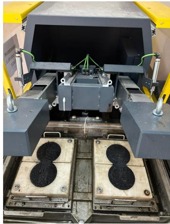
Image 6 : Éprouvettes du béton bitumineux semi-grenu 0/14 après essai d’orniérage
