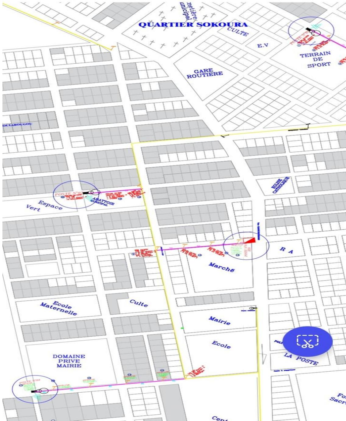
Figure 23 : Plan d'exécution du réseau HTA
