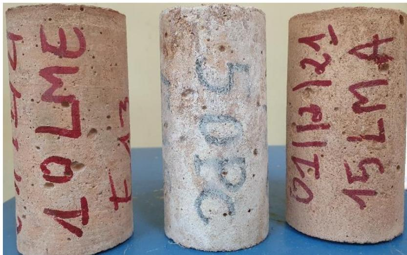
Figure 125 Eprouvettes de béton non-carbonaté (10SLM à gauche et 15QLM à droite) et carbonaté (50PC au centre)
