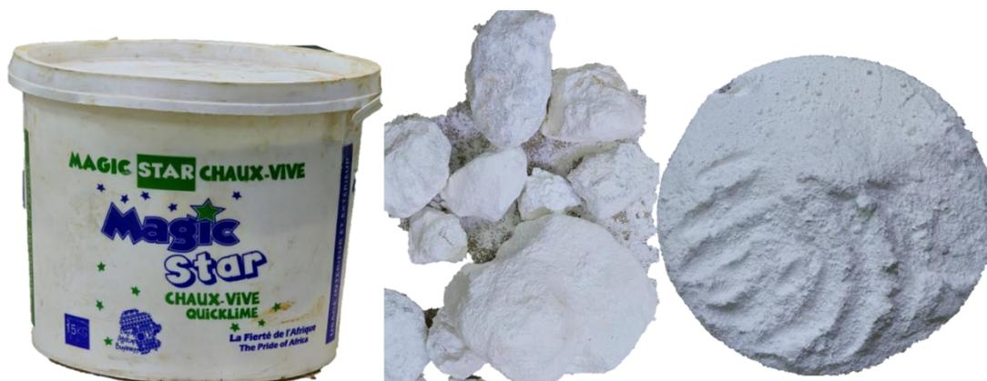
Figure 17. Chaux vive : boîte de conditionnement (à gauche) ; granulés de chaux vive (centre) ; chaux vive broyée (droite)
