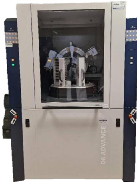
Figure 26. Diffractomètre Bruker D8 Advance
