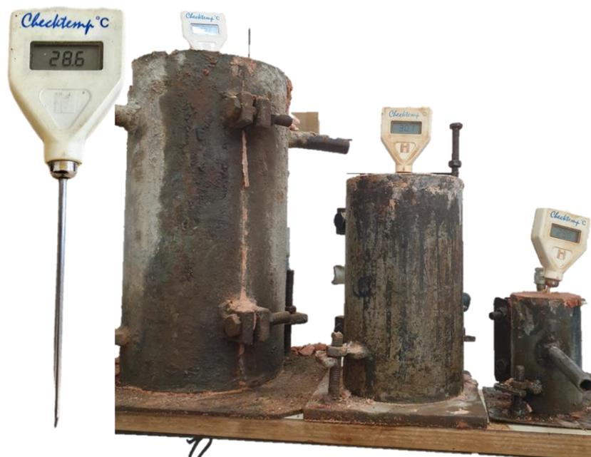
Figure 122. Dispositif de suivi de la température in-situ de bétons géopolymères de tailles différentes
