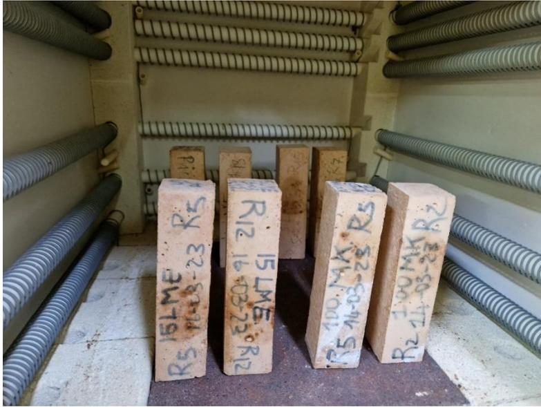
Figure 38. Disposition des échantillons de béton dans le four pour l'exposition à haute température
