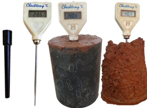
Figure 32. Dispositif de mesure de la température des bétons après malaxage
