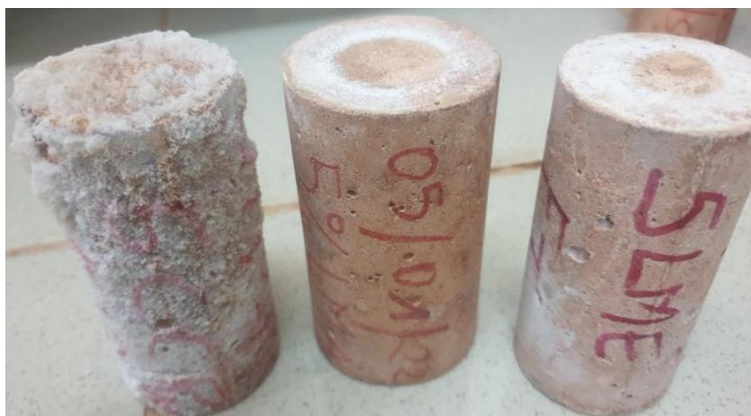
Figure 126. Photo montrant des échantillons de béton 5CCR (à gauche) 5QLM (au centre) et 5SLM (à droite) dans les mêmes conditions de conservation
