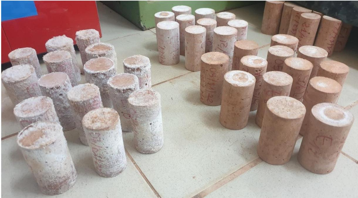
Figure 127. Photo montrant des échantillons de béton carbonaté et non carbonatés dans les mêmes conditions de conservation
