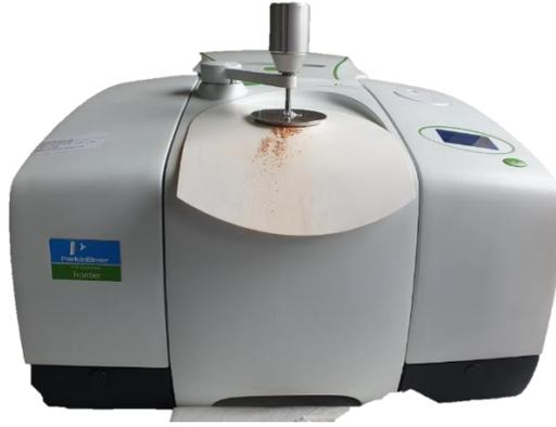
Figure 27. Spectromètre PerkinElmer UATR1 Frontier
