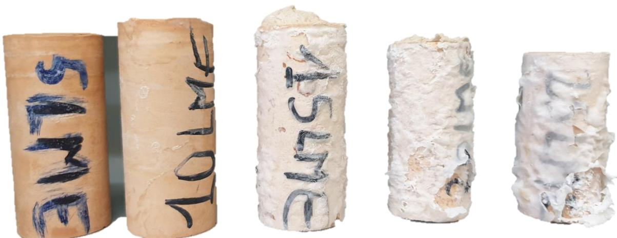
Figure 128. Aspect visuel de pâtes géopolymères contenant différentes proportions de chaux éteinte SLM
