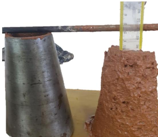
Figure 30. Dispositif de mesure de l'ouvrabilité (affaissement) du béton frais
