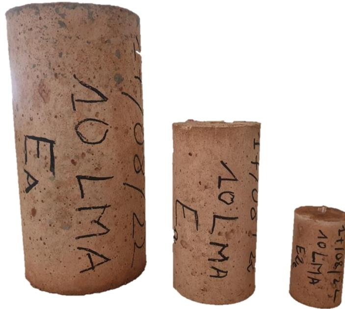
Figure 123. Bétons géopolymères 10QLM de tailles diverses : de gauche à droite  $\Phi$  160 mm  $\times$  H 320 mm ;  $\Phi$  100 mm  $\times$  H 200 mm et  $\Phi$  50 mm  $\times$  H 100 mm
