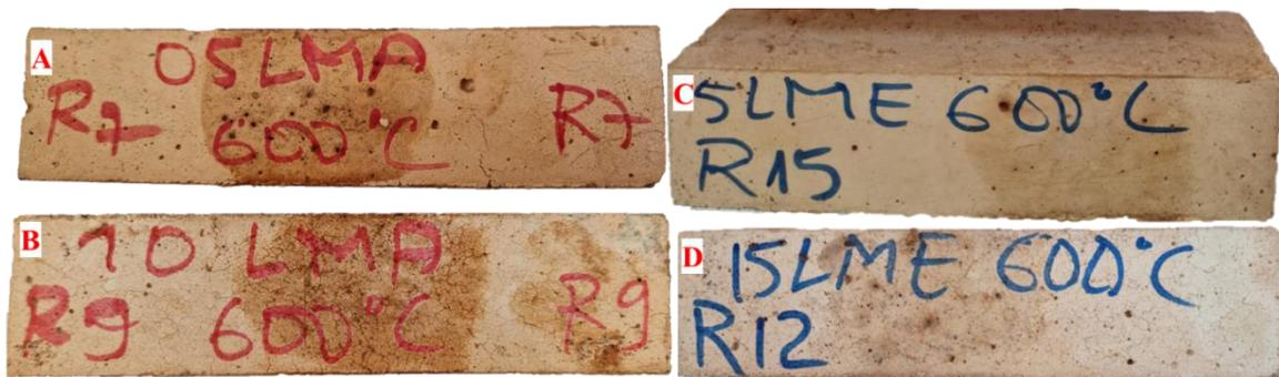
Figure 107. Aspect visuel des bétons géopolymères après 2 heures d'exposition à 600°C :
