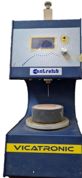
Figure 31. Appareil de VICAT automatique
