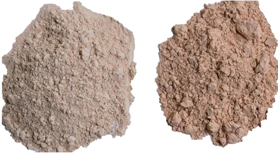
Figure 15. Aspect visuel de l'argile brute (à gauche) et de l'argile calcinée (à droite)
