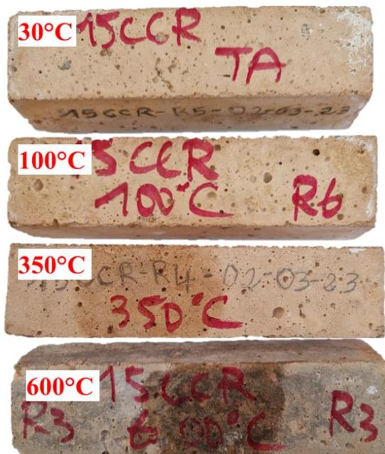
Figure 108. Aspect visuel du béton 15CCR après exposition à différentes températures
