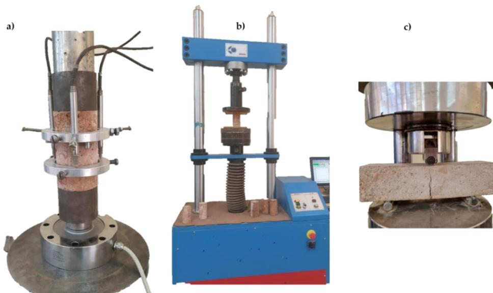
Figure 36. Dispositif des essais mécaniques : capteurs LVDT (a) ; Presse hydraulique (b) ; flexion 3 points (C)
