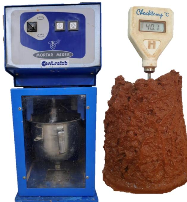
Figure 22. Malaxeur utilisé (à gauche) ; aspect des bétons à l'état frais (droite)
