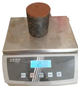
Figure 33. Dispositif de mesure de la masse volumique apparente des bétons à l'état frais
