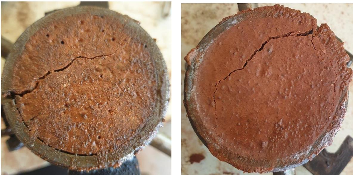
*Figure 129. Apparition de fissures lors du démoulage des bétons*
