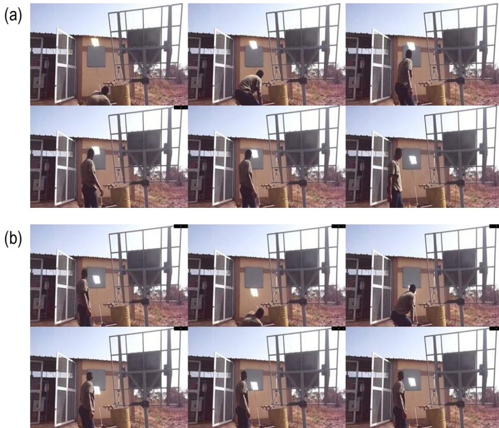
Figure D.11 : Test d'autocorrection de la déviation a) vers le haut et b) vers le bas de la tache focale le 24 mai 2023
