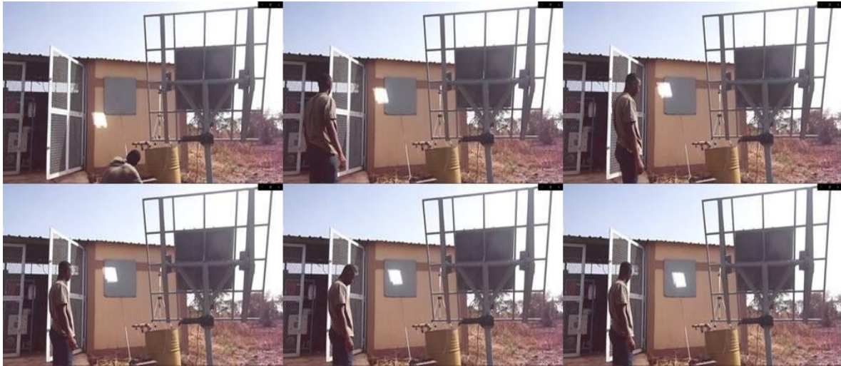
Figure D.13 : Test d'autocorrection de la déviation de la tache focale vers la diagonale inférieure gauche le 24 mai 2023
