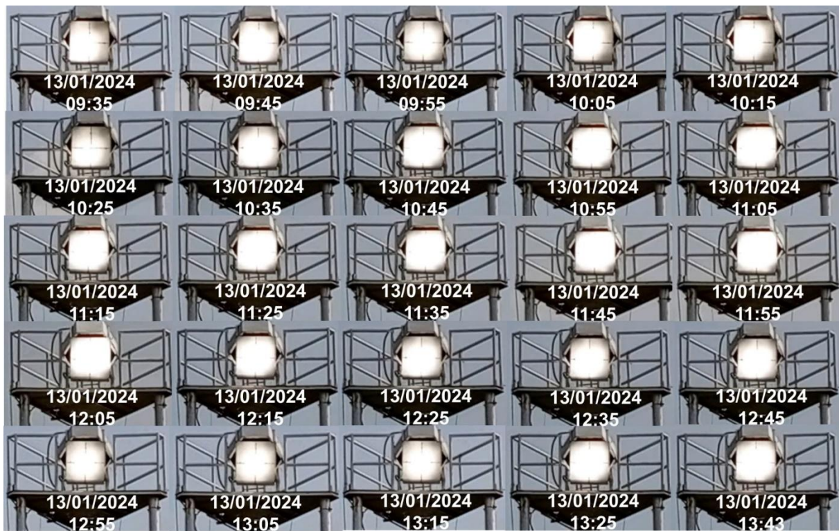
Figure C.7: Séquence d'images de la tache focale lors du test de suivi solaire effectué le 13 janvier 2024.
