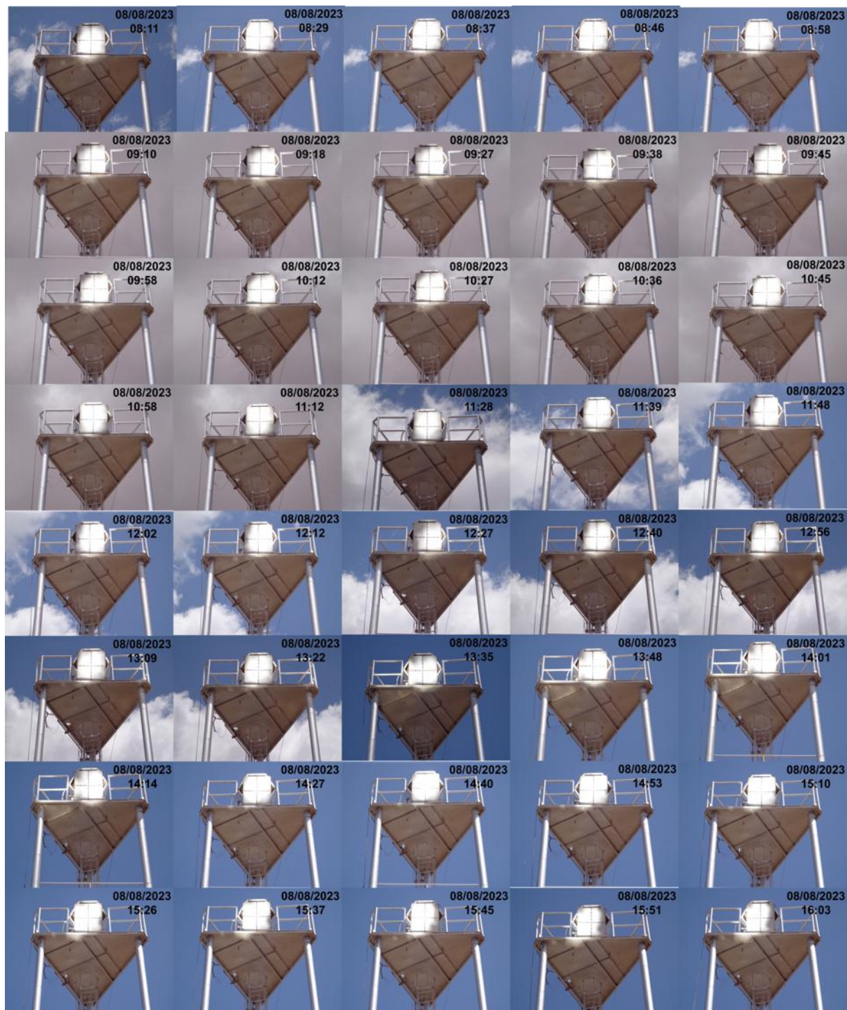
Figure 41: Séquence d'images de la tache focale pendant le test de suivi solaire conduit le 08 Aout 2023.
