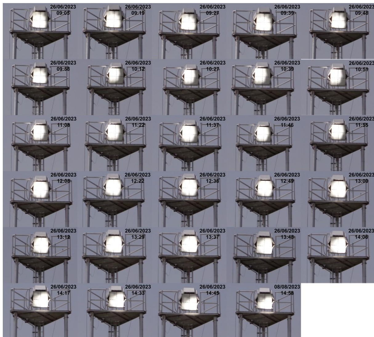
Figure C.1: Séquence d'images de la tache focale lors du test de suivi solaire effectué le 26 juin 2023.
