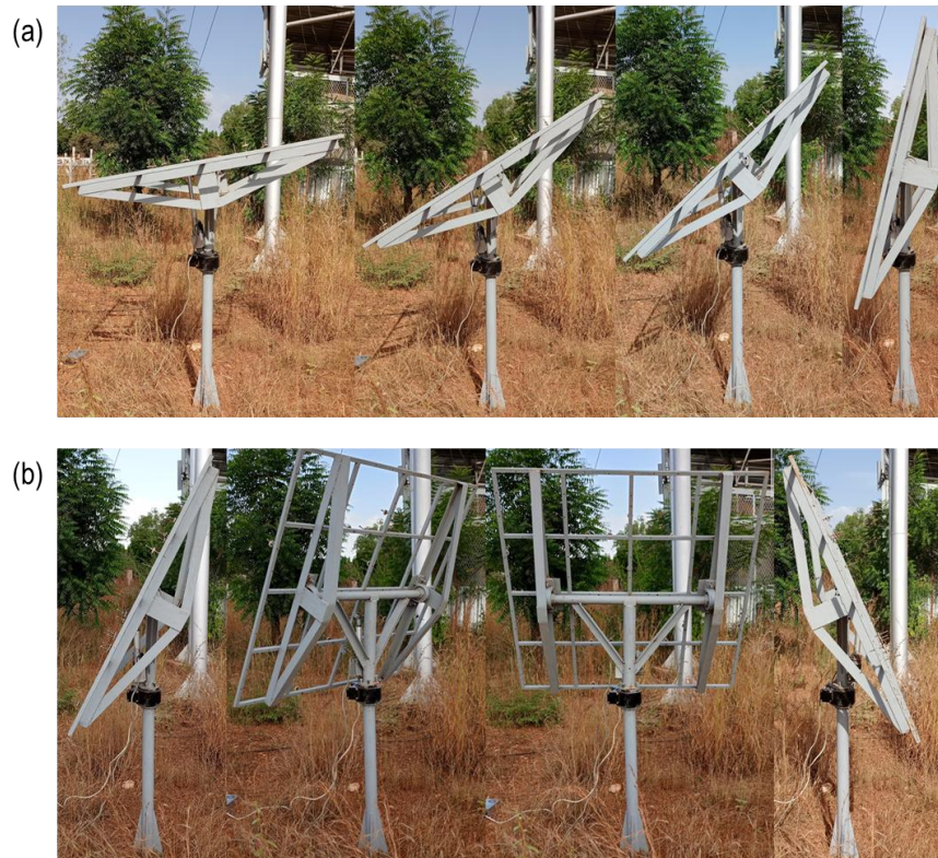
Figure D.10 : Variation de a) l'inclinaison de la structure de support de l'héliostat entre 0° et 90° et de b) l'orientation entre 0° et 180°
