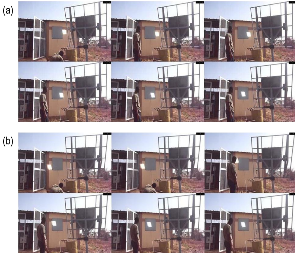
Figure D.12 : Test d'autocorrection de la déviation a) vers la droite et b) vers la gauche de la tache focale le 24 mai 2023
