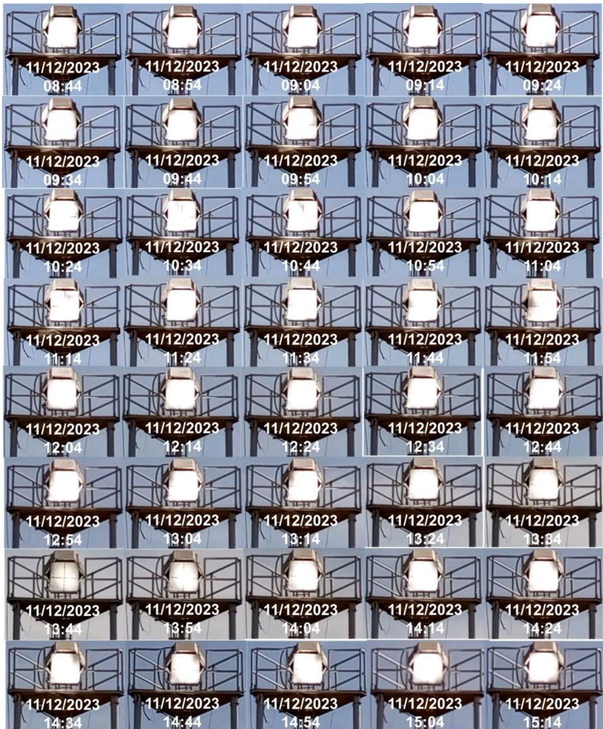
Figure C.6: Séquence d'images de la tache focale lors du test de suivi solaire effectué le 11 décembre 2023.
