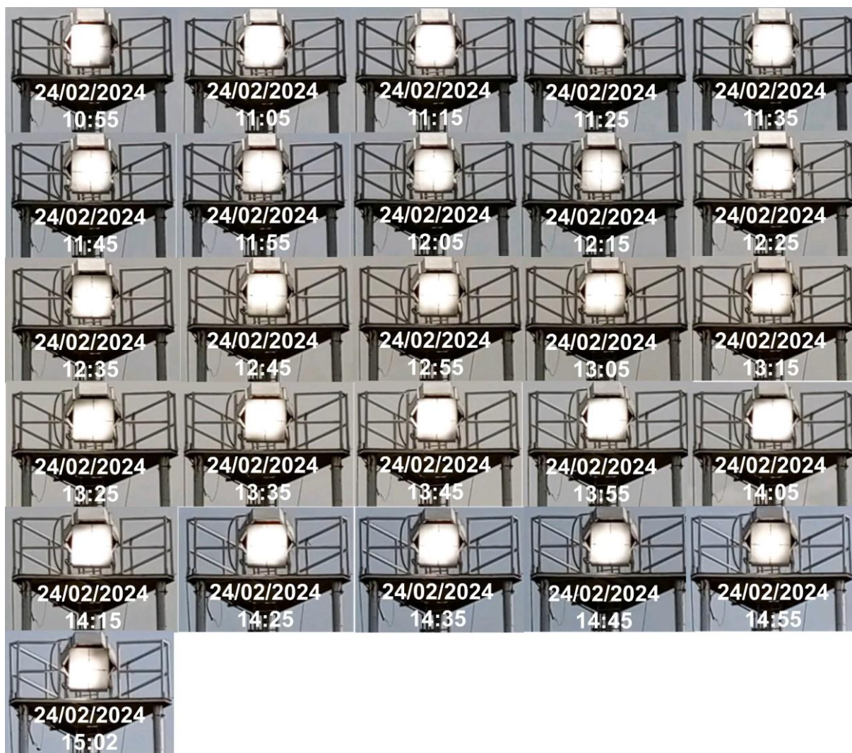
Figure C.8: Séquence d'images de la tache focale lors du test de suivi solaire effectué le 24 février 2024
