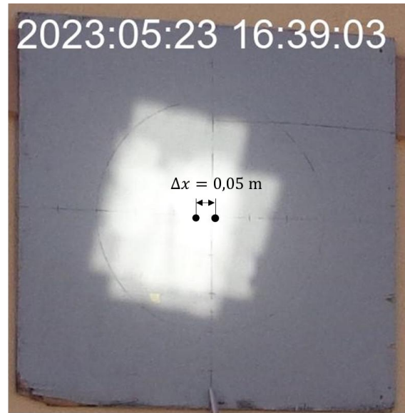
Figure D.18: Tache focale de l'héliostat a) au début et b) la fin du test de suivi solaire réalisé le 17 mai 2023.
