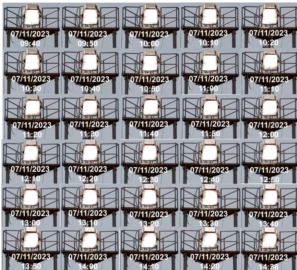
Figure C.4: Séquence d'images de la tache focale lors du test de suivi solaire effectué le 7 novembre 2023.
