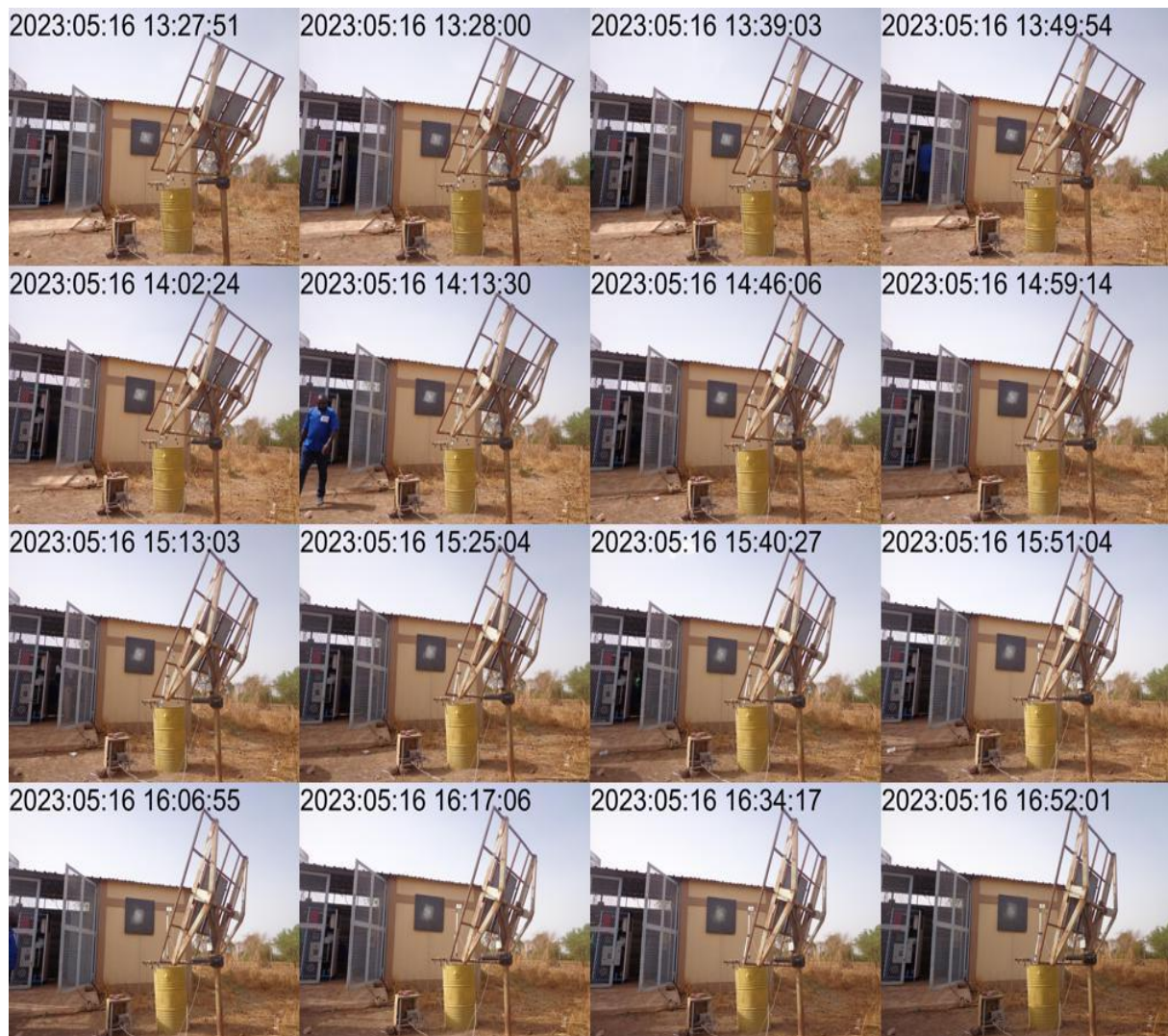
Figure D.15: Séquence d'images de la tache focale lors du test de suivi solaire effectué le 16 mai 2023.
