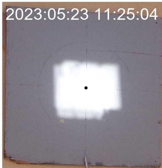
Figure D.18: Tache focale de l'héliostat a) au début et b) la fin du test de suivi solaire réalisé le 17 mai 2023.
